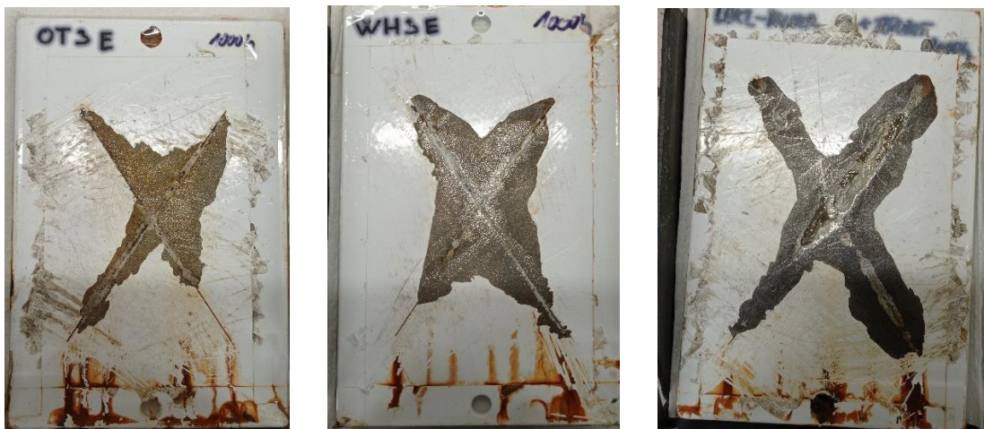
Obr. 63 - Delaminace po 1 000 h
