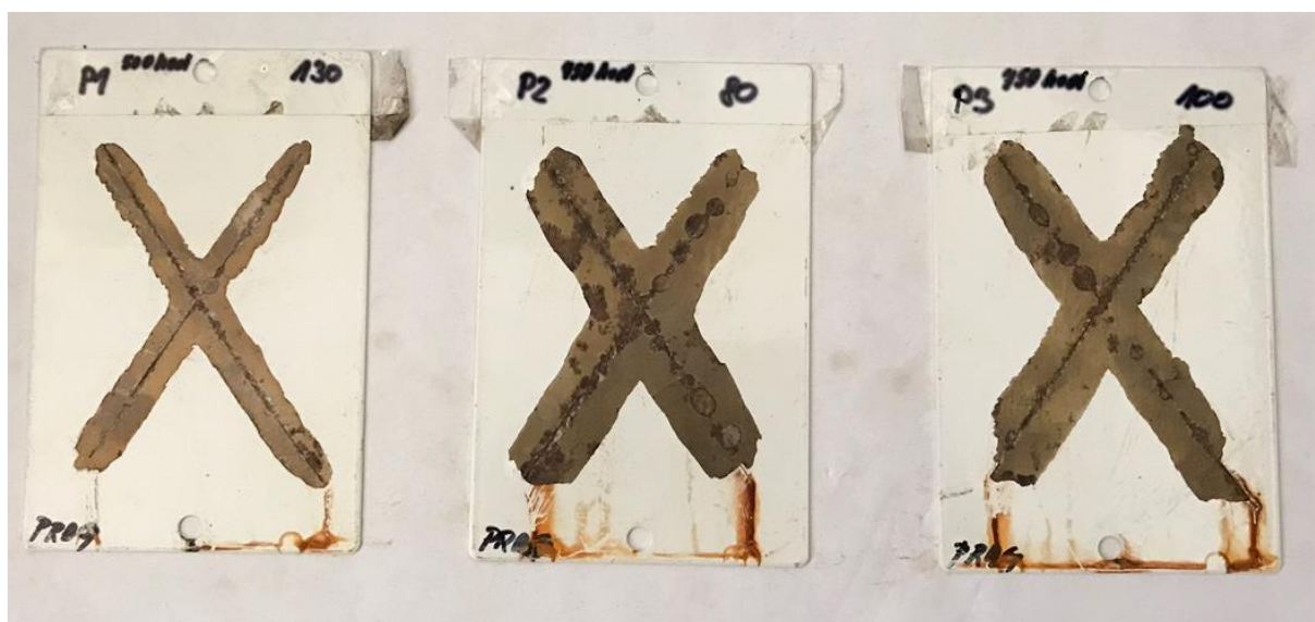
Obr. 19 - Pragochema: Rad10 + NZP, CRS – vlevo 500 h, uprostřed 750 h, vpravo 750 h
