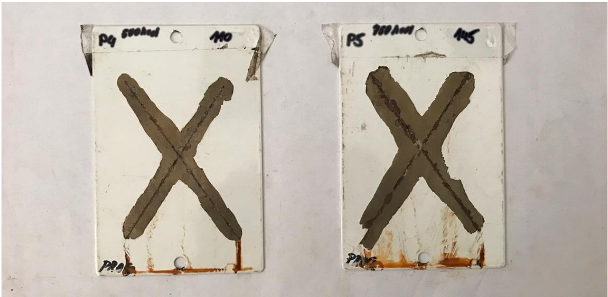
Obr. 21 - Pragochema: Rad10 + NZP + silan, CRS – vlevo 500 h, vpravo 750 h
