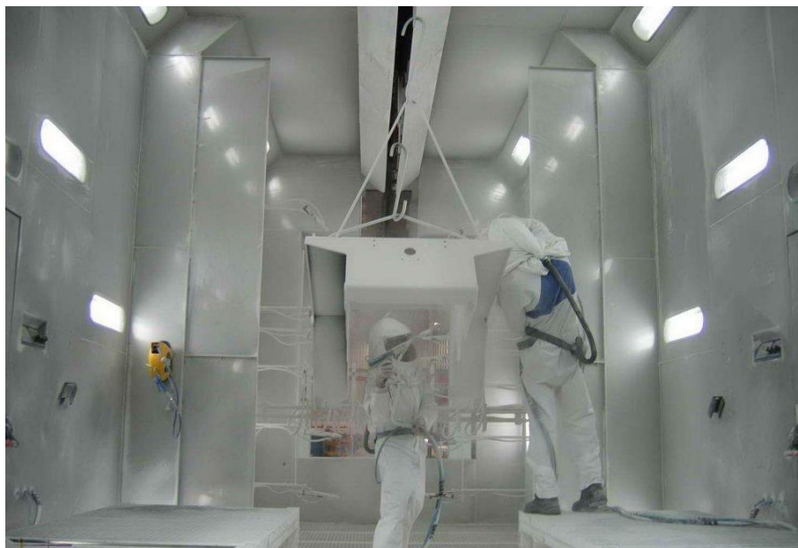
Obr. 18 - Ruční dostřik za automatickou kabinou [33]
