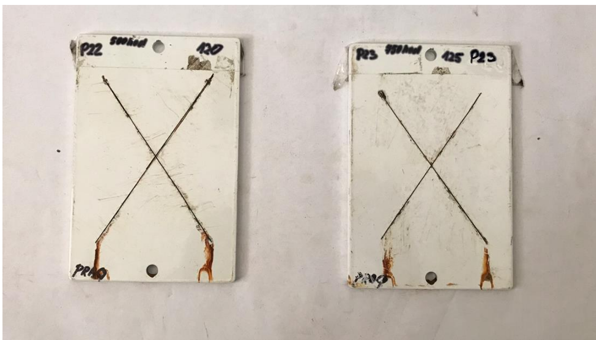
Obr. 26 - Pragochema: 1008M + NZP + silan, HRS – vlevo 500 h, vpravo 750h
