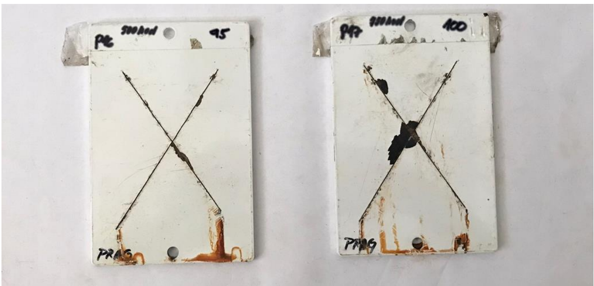
Obr. 22 - Pragochema: Rad10 + NZP + silan, HRS – vlevo 500 h, vpravo 750 h
