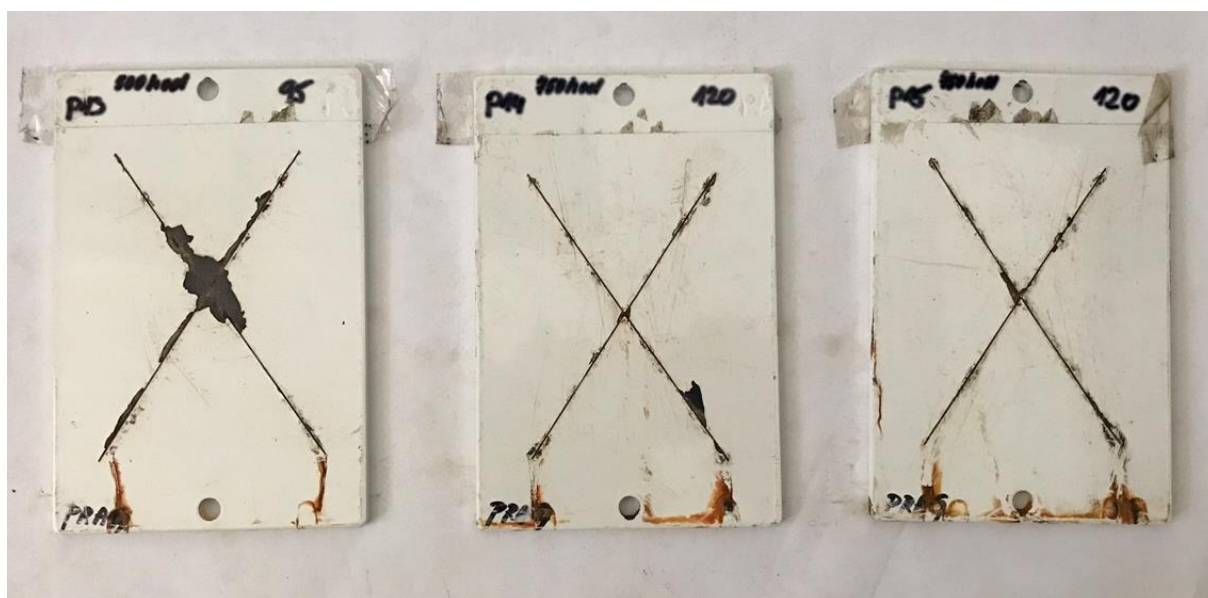
Obr. 20 - Pragochema: Rad10 + NZP, HRS – vlevo 500 h, uprostřed 750 h, vpravo 750 h
