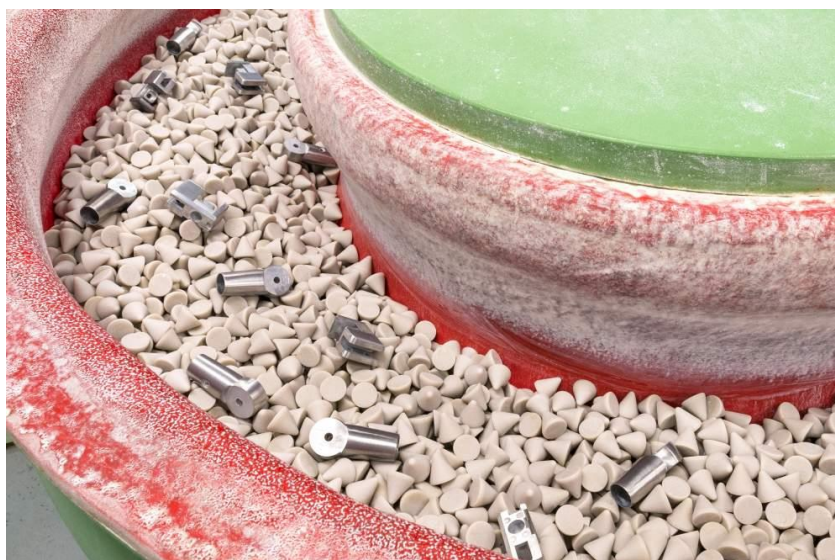
Obr. 4 - Omílací tělíska a omílané díly ve vibračním zařízení [12]
