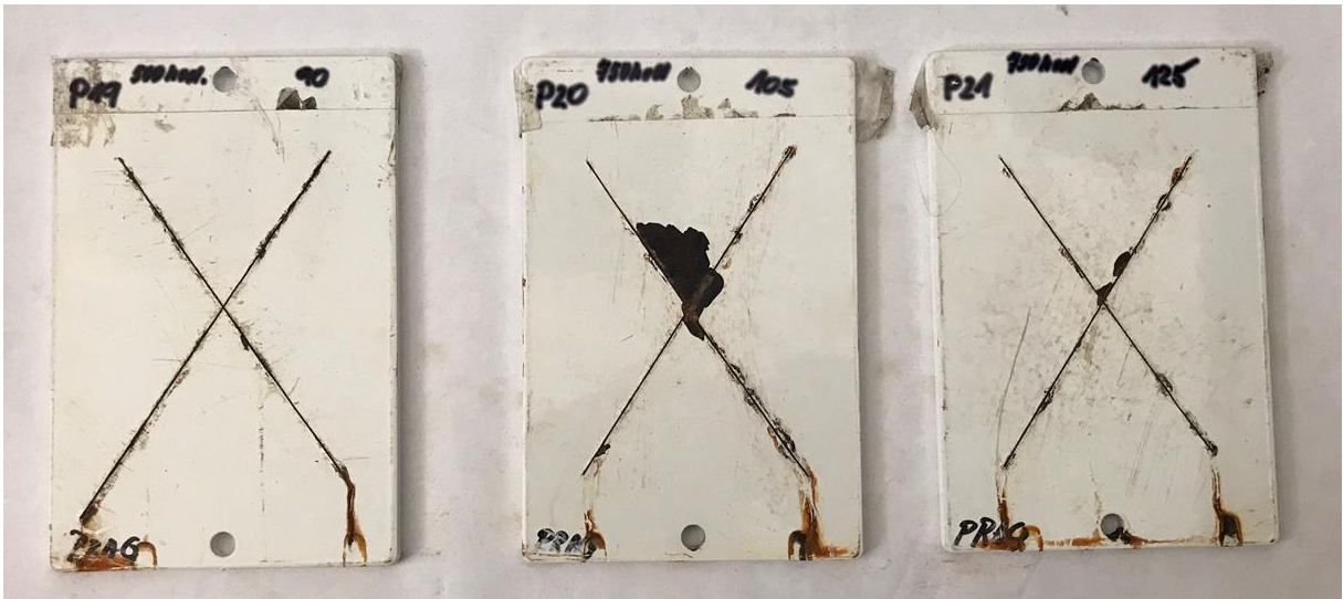
Obr. 24 - Pragochema: 1008M + NZP, HRS – vlevo 500 h, uprostřed 750 h, vpravo 750 h
