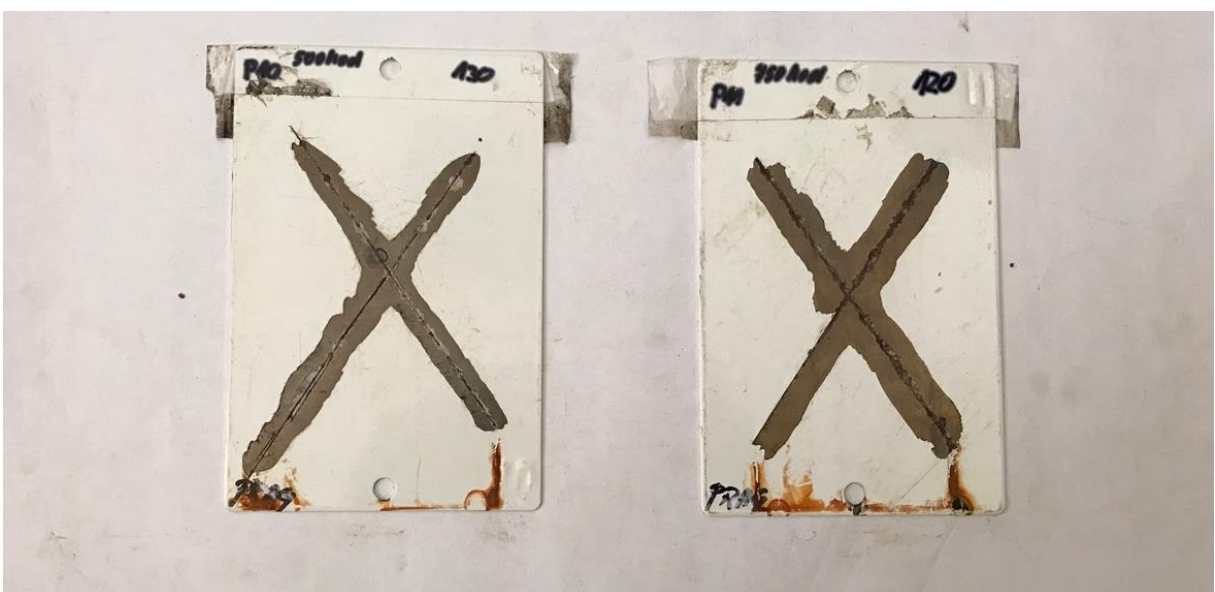
Obr. 25 - Pragochema: 1008M + NZP + silan, CRS – vlevo 500 h, vpravo 750h
