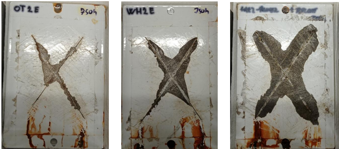
Obr. 62 - Delaminace po 750 h
