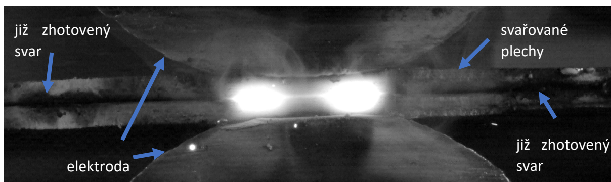
Obr. 34 Vliv odbočování proudu nebo-li shuntování
