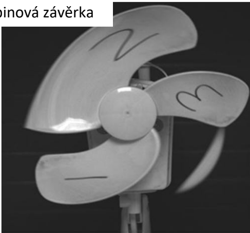
Obr. 3 Záznam pohyblivého se předmětu šterbinovou závěrkou (vlevo) a centrální závěrkou (vpravo) [6]
