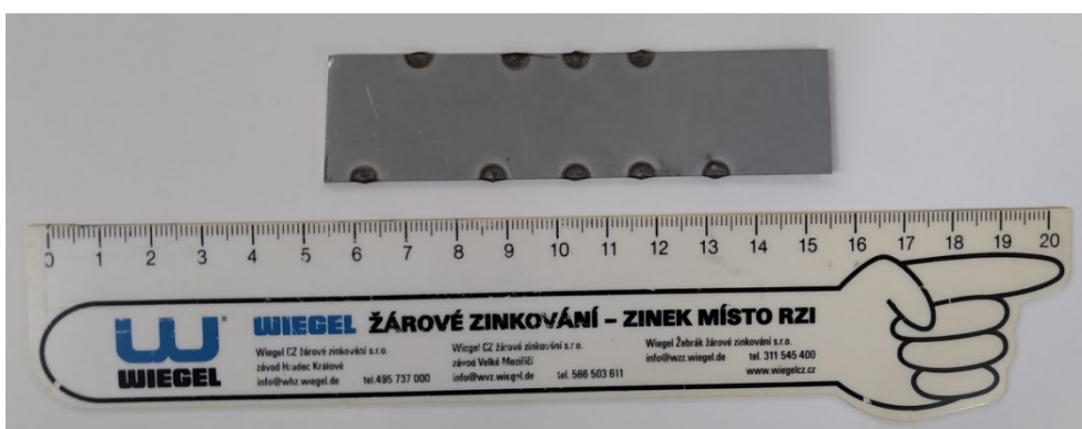
Obr. 39 Umístování svarů na zkušební vzorek
