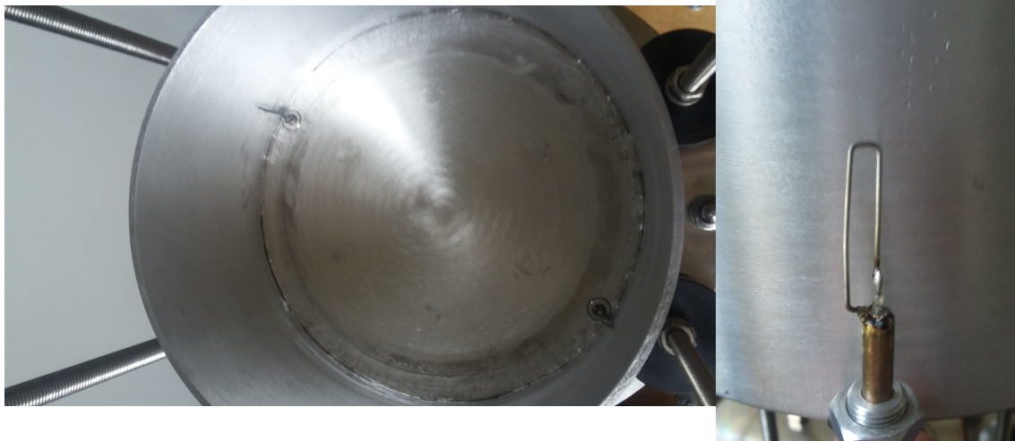
Obrázek 3.7: a) Poloha původních antén v dutině. b) Jedna z původních antén zblízka.
