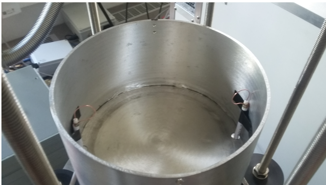
Obrázek 3.15: Poloha nových 5 cm antén: uprostřed výšky, v blízkosti stěny dutiny. Antény natočeny tak, aby vytvářené/detekované magnetické pole bylo v dutině azimutální.
