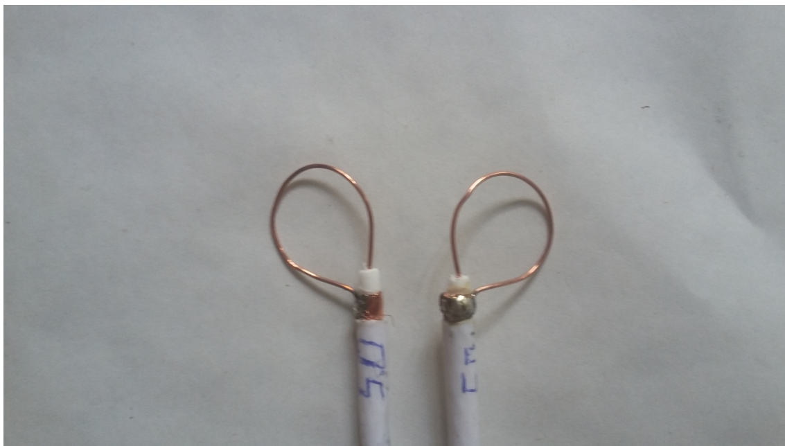
Obrázek 3.14: Nové antény s obvodem smyčky 5 cm.
