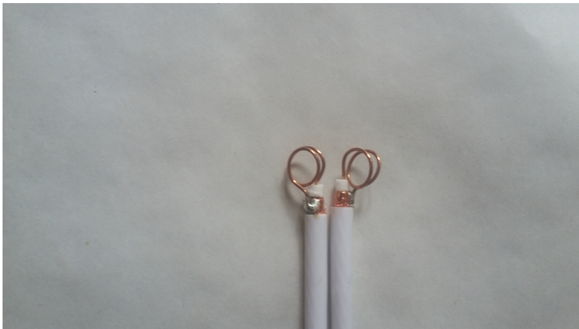
Obrázek 3.21: Antény s obvodem smyčky 2,5 cm.
