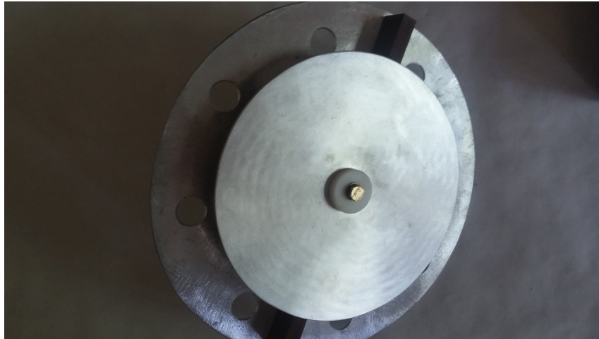
Obrázek 2.3: Poklice s hliníkovou elektrodou.
