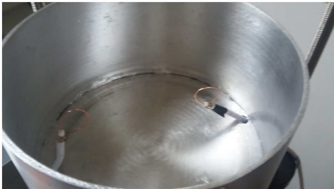
Obrázek 3.17: Poloha nových 5 cm antén: uprostřed výšky, uprostřed poloměru dutiny. Antény natočeny tak, aby vytvářené/detekované magnetické pole bylo v dutině azimutální.
