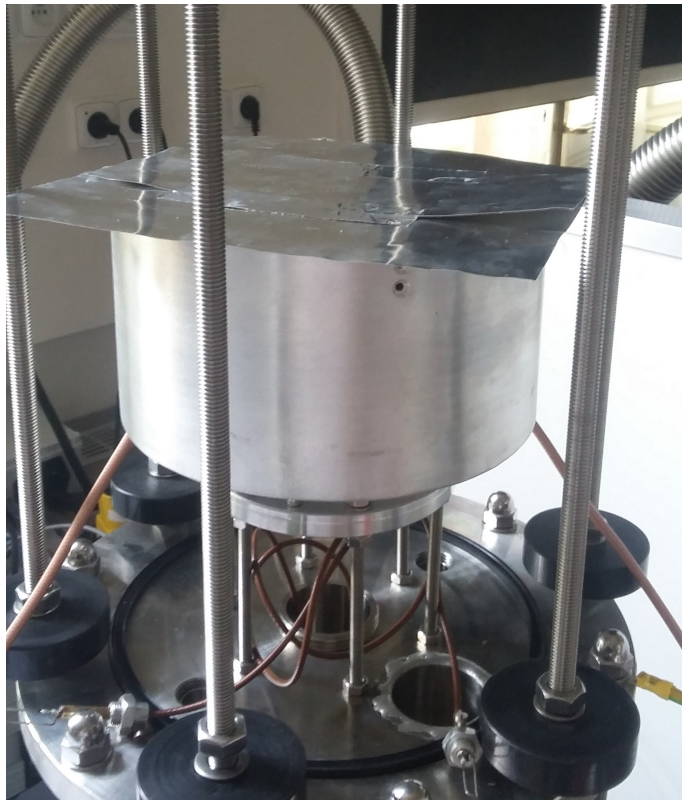
Obrázek 3.11: Rezonanční dutina s provizorní hliníkovou poklicí.
