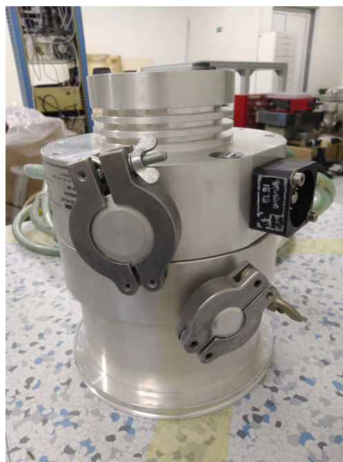
Obrázek 2.4: Turbomolekulární vývěva pro čerpání interakční komory.
