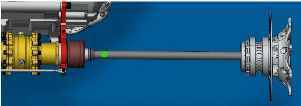
Obrázok č.49: Umiestnenie tenzometra je znázornené zelenou značkou
