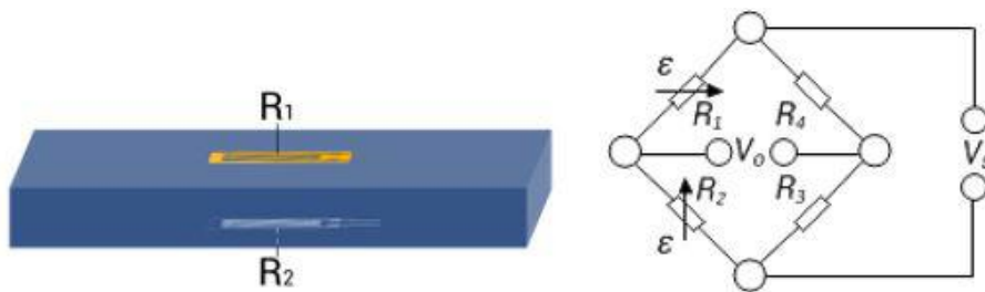
Obrázok č. 46: Schéma zapojenia tenzometru do jednoduchého polmostíka
