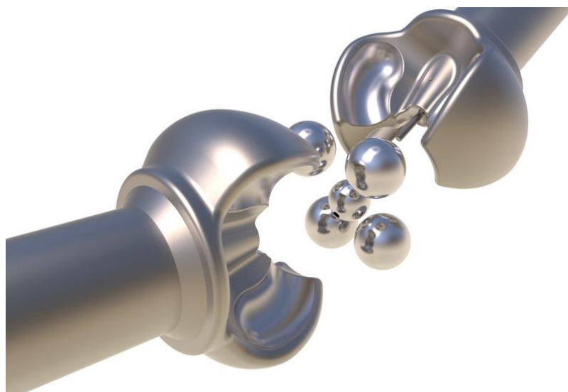
Obrázok č.23: dva unášače a guličky weissovho homokinetického kĺbu, na pravom unášači vidno kolík na zaistenie guličky[12]
