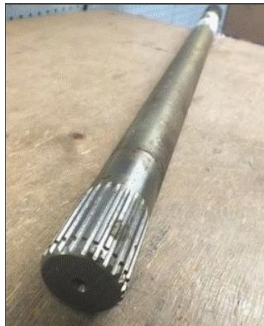
Obrázok č.16: Homokinetický kĺb zaistený koncom drážkovania a poistným krúžkom [6]
