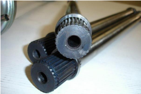
Obrázok č. 17: Vývrt po celej dĺžke hnacieho hriadeľa z dôvodu odľahčenia [7]
