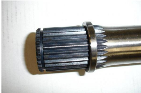
Obrázok č. 18: Zaistenie homokinetického kĺbu krúžkom nalisovaným na drážkovaní ktorí plní funkciu osadenia na jednej strane a poistným krúžkom na druhej strane[7]
