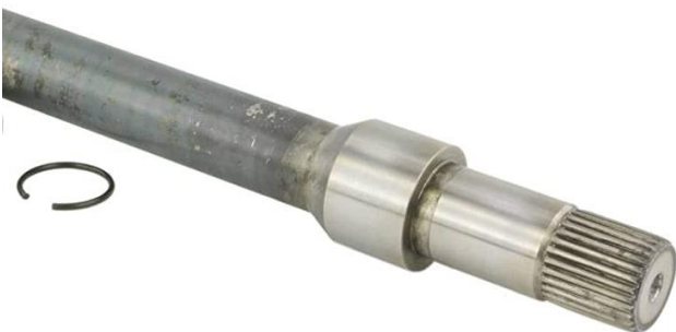
Obrázok č. 15: Homokinetický kĺb zaistený osadením a poistným krúžkom [5]
