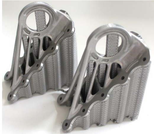
Obrázek 10: Díly vytištěné metodou SLM s podpurnými strukturami [18]
