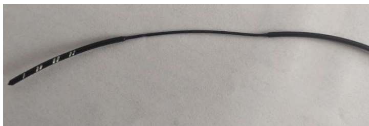
Obrázek 39 Vzorek PETG s vytvořeným krčkem během tahové zkoušky
