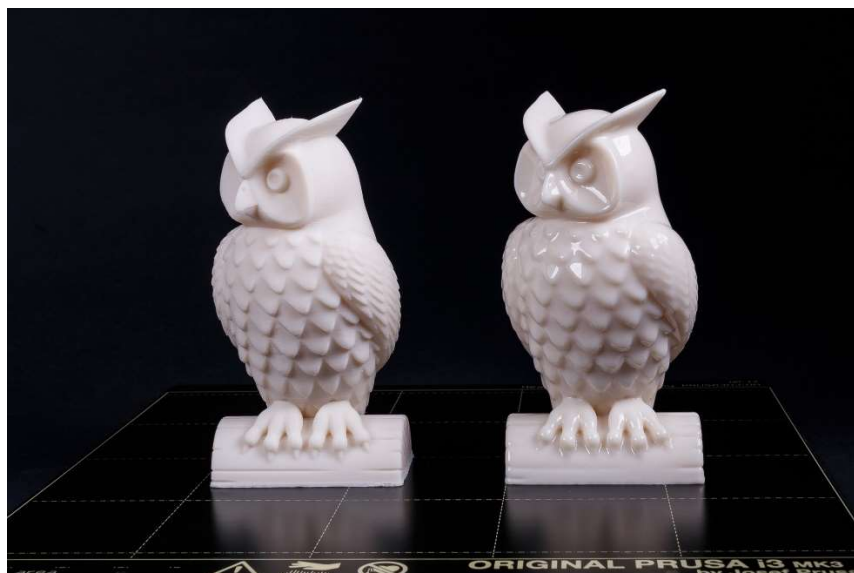
Obrázek 6 Vlevo – výrobek z ABS – Vpravo výrobek z ABS vyhlazený pomocí acetonových par [12]
