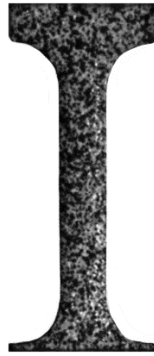
Obr. 40 – Čelní plocha miniaturizovaného zkušební tělesa se stochastickým paternem pro možnost bezkontaktního měření deformace
