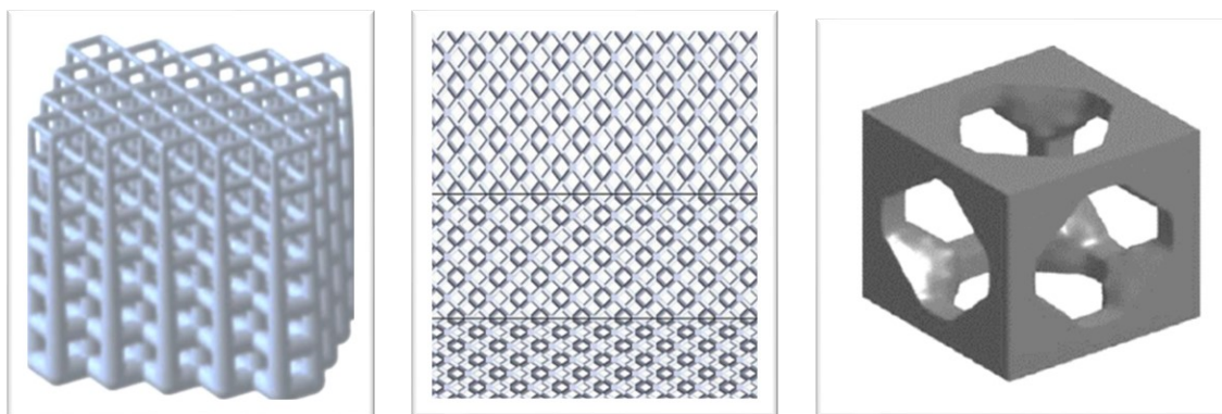
Obr. 17 – Lattice structure s kontinuálním průběhem porozity (vlevo) [26], Lattice structure s diskontinuálním průběhem porozity (uprostřed) [26], topologicky optimalizovaná základní buňka (vpravo) [24]
