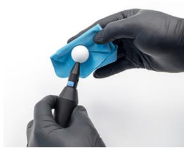
Obr. 65: Příklad čištění kalibrační koule [47]
