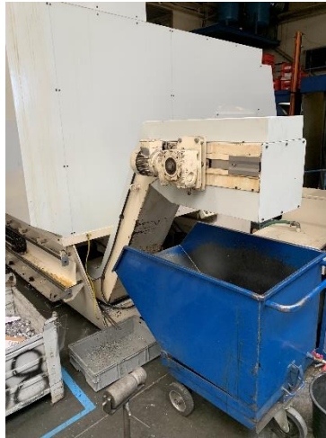
Obr. 46 Dopravník špon a manipulační vozík
