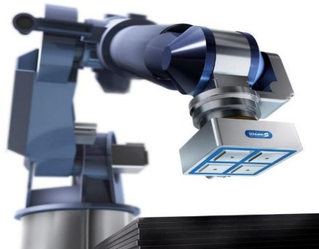
Obr. 37 Aktivní magnetický efektor [35]
