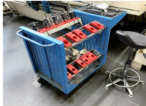
Obr. 44 Vozík pro transport nástrojů na pracoviště
