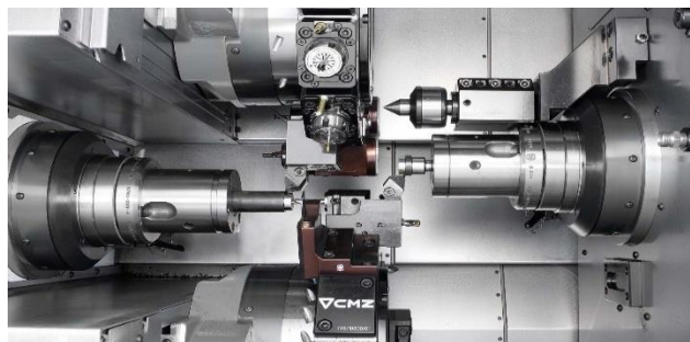
Obr. 20 Pracovní prostor soustruhu CMZ TTS SERIES [23]
