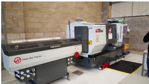
Obr. 18 Stroj s automatickým podavačem tyčí Haas [22]
