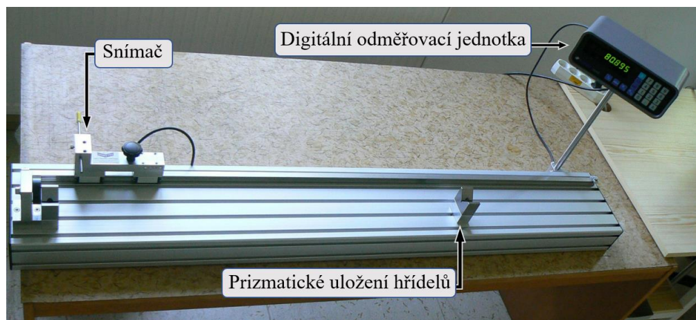
Obrázek 23: Odměřování délek hřídelů pomocí snímače a digitální odměřovací jednotky [21]
