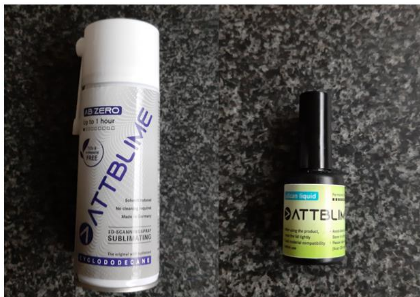
Obr. 61 Zvolené matnící přípravky, vpravo AB ZERO, vlevo \mu\text{Scan liquid}
