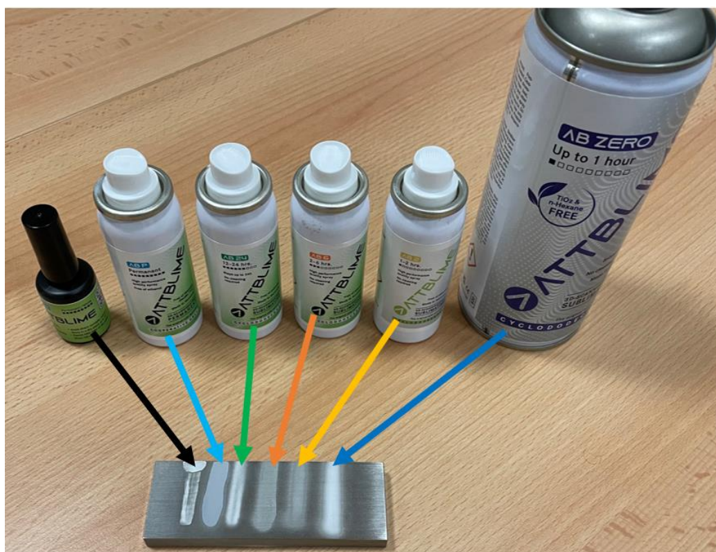
Obr. 62 Testovací nástřiky (zleva μScan liquid, ABP, AB 24, AB 6, AB 2 a AB ZERO)
