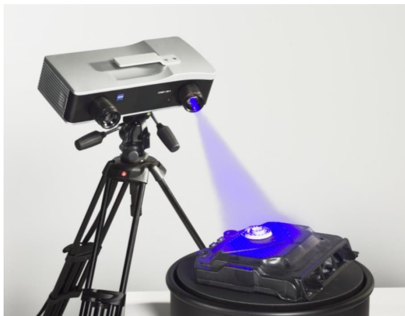
Obr. 17 Skener Comet LED 2 pracující na principu projekce modrého světla [5]
