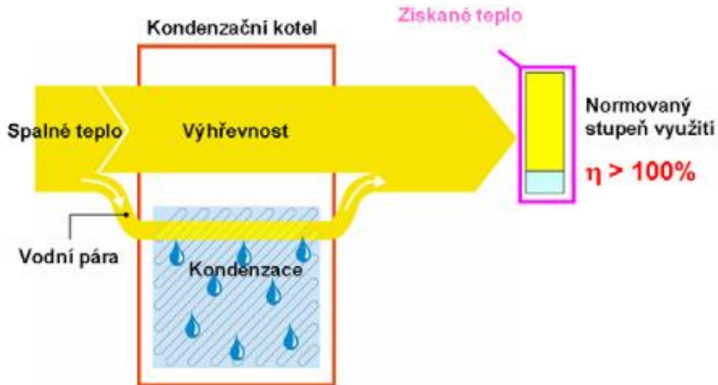
Obr. 3.12: Proces spalování kondenzačního kotle [39]
