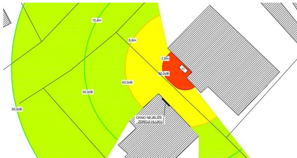
Obr. 3.11: Běžné tepelné čerpadlo s hladinou akustického výkonu 67 dB [34]
