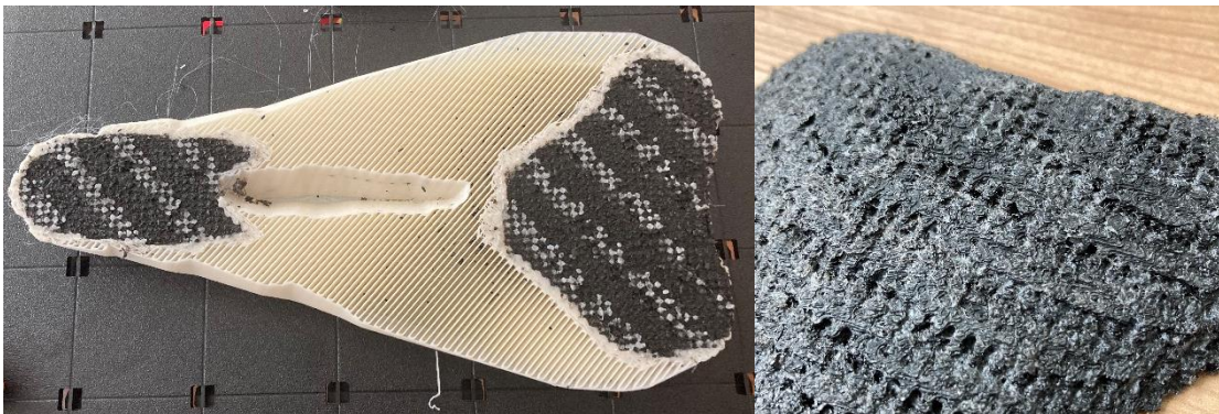
Obrázek 102: Vlevo - průběh tisku na Stratasys; Vpravo - detail výtisku
