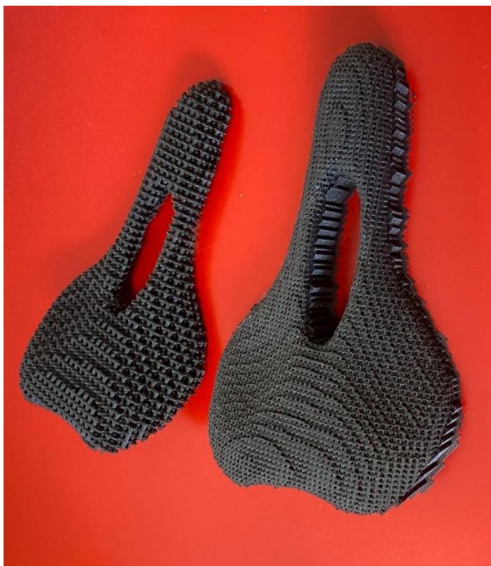
Obrázek 100: Hrubé (vlevo) a jemné (vpravo) sedlo vytisklé na Průša tiskárně
