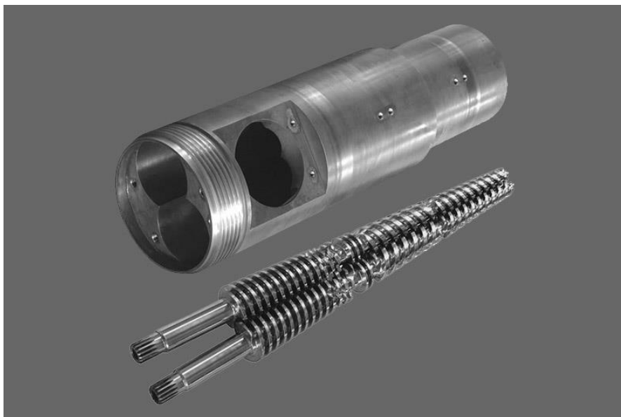
Obrázek 14: Vytlačovací komora a šneky dvoušnekového vytlačovacího stroje (14)
