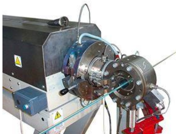
Obrázek 17: Příčná vytlačovací hlava při opláštění drátu (17)
