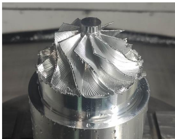
Obrázek 72: stav lopatkového kola po 2. části hrubování a dohrubování
