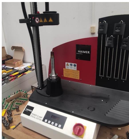
Obrázek 70: vložení nástroje určeného pro lopatkové strategie do tepelného upínače
