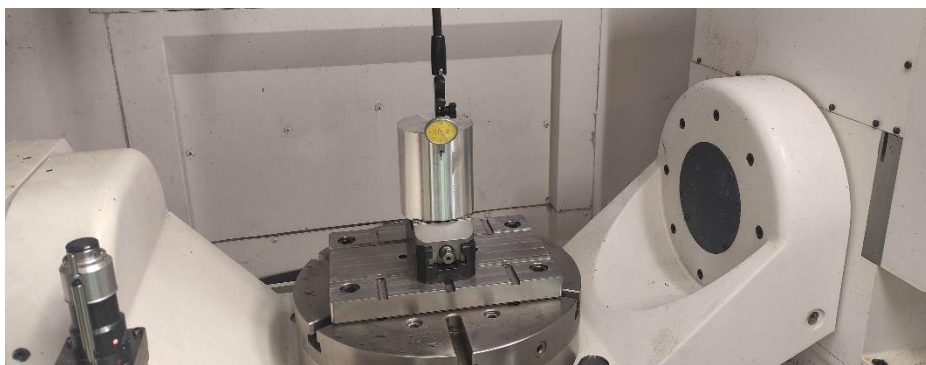
Obrázek 68: středění polotovaru na stroji Okuma MU 400V II
