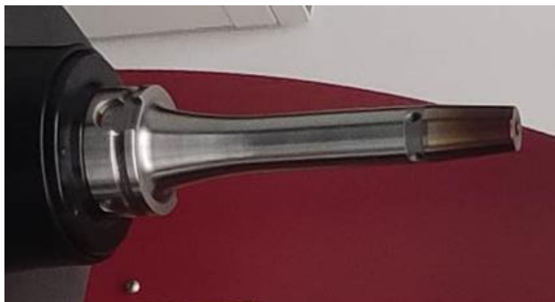
Obrázek 49: tepelný upínač Haimer DIN 69893-1 HSK-A63
