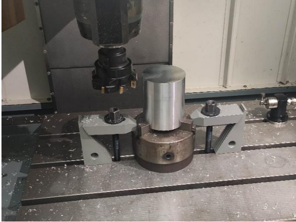
Obrázek 67: zobrazení upnutí prvotního polotovaru pro výrobu osazení
