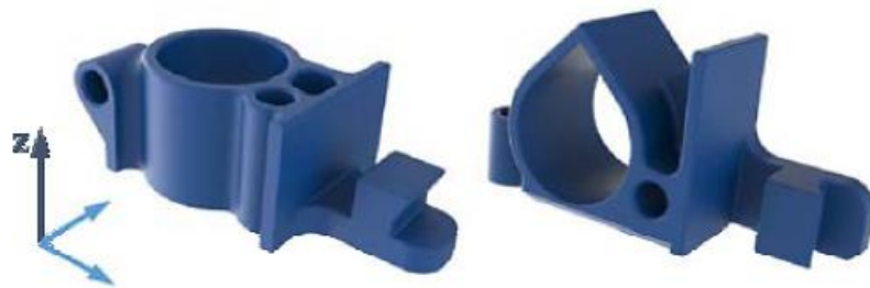
Obrázek 16 Vliv orientace vůči tisku na design součásti [26]
