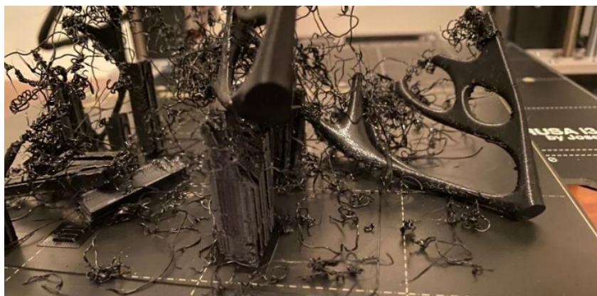
Obrázek 74 Selhání tisku s minimem podpěr
