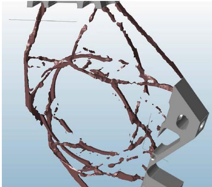
Obrázek 23 Problém vzniklý během topologické optimalizace [27]
