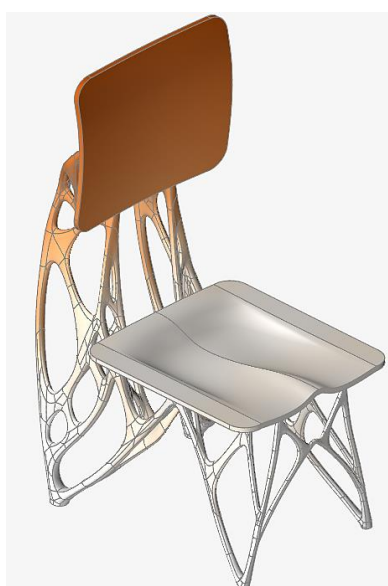
Obrázek 62 Posunutí v rámci přemodelovaného objektu (varianta 2 – finální verze)
