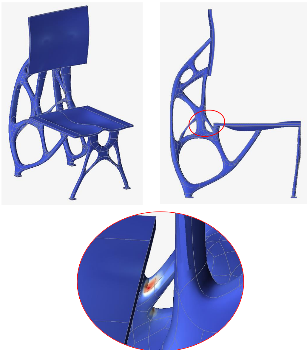
Obrázek 58 Maximální hodnota napětí von Mises pro přemodelovaný objekt (varianta 1)
