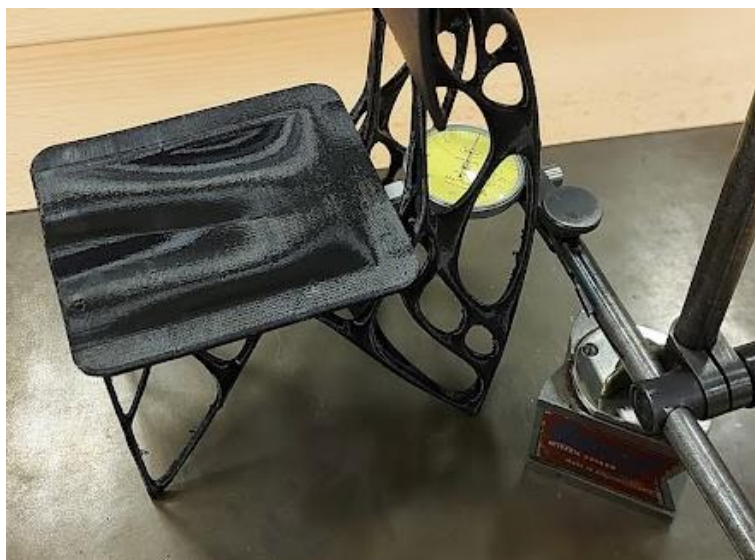
Obrázek 79 Průběh měření posunutí ve vybraném bodě
