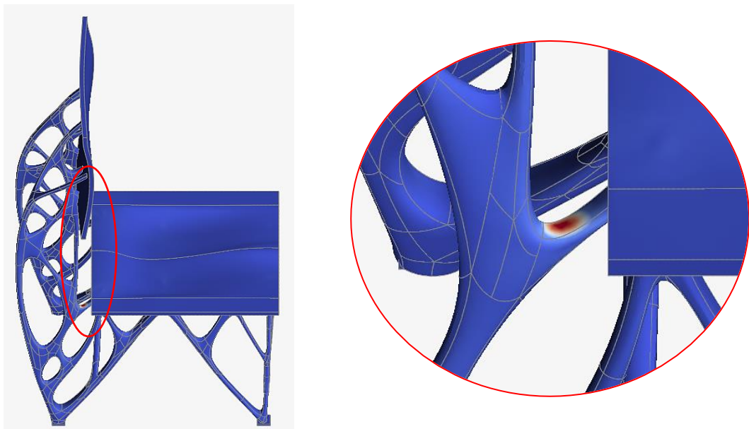
Obrázek 60 Kritické místo s maximální hodnotou napětí von Mises (varianta 2)
