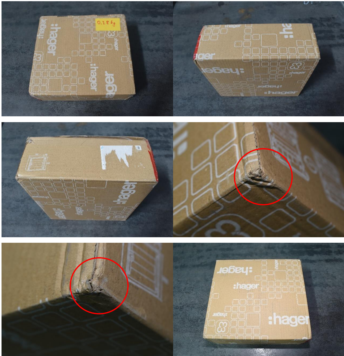
Obr. 63: Testované přepravní balení po A – Handling – First Sequence
