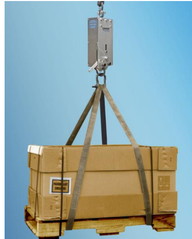
Obr. 23: Pádové zařízení s mechanismem rychlého uvolnění (převzato z [16])
