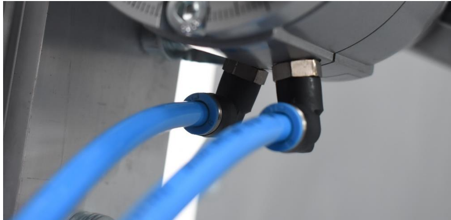
Obr. 45: Šroubení tvaru L ústící z kyvného pohonu
