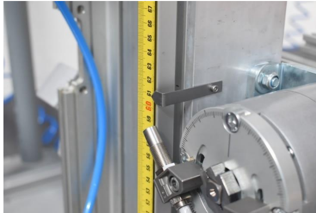
Obr. 43: Část svinovacího metru upevněná na nosný profil
