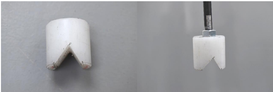
Obr. 46: Polypropylenová dosedací část přídržovače
