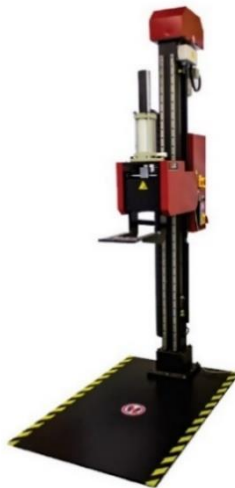
Obr. 20: Pádové zařízení s jedním ramenem (převzato z [16])
