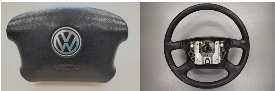
Obr. 67: Testovaný modul volantového airbagu a volant
