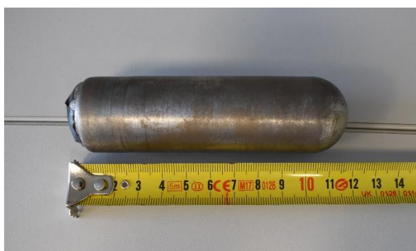
Obr. 61: Impaktor pro zkoušku koncentrovaným nárazem
