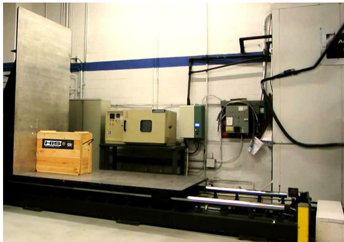
Obr. 6: Nárazová zkouška na náběžné hraně (převzato z [12])
