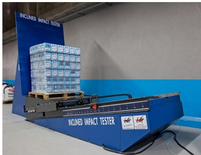
Obr. 7: Nárazová zkouška po nakloněné rovině (převzato z [12])
