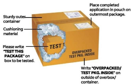
Obr. 66: Příklad výplně přepravního balení pro výkonnostní zkoušky (převzato z [14])
