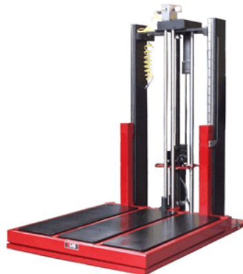
Obr. 22: Pádové zařízení s padajícím kontejnerem (převzato z [16])
