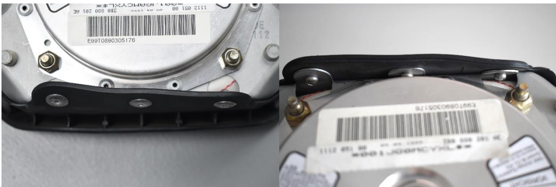
Obr. 72: Modul volantového airbagu po pádové zkoušce ve směru +Z
