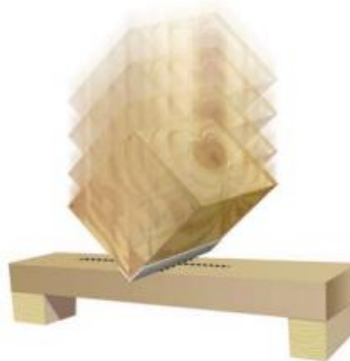
Obr. 10: Bridge Impact Test Procedures dle ISTA 6-FedEx-A (převzato z [14])
