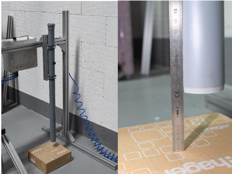
Obr. 62: Zkouška koncentrovaným nárazem přepravního balení
