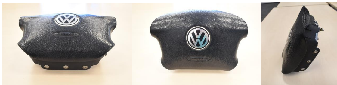
Obr. 14: Poloha pádů modulu volantového airbagu v osách Y, Z, X
