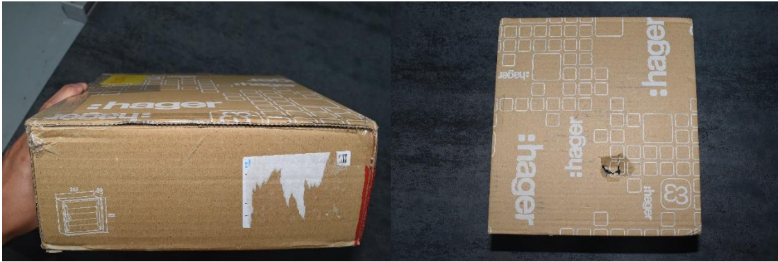
Obr. 65: Testované balení po A – Handling – Second Sequence
