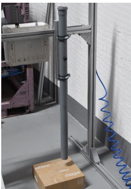
Obr. 51: Pádové zařízení pro přepravní balení
