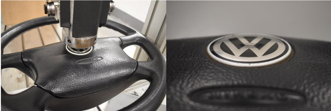
Obr. 71: Modul volantového airbagu po nárazové zkoušce
