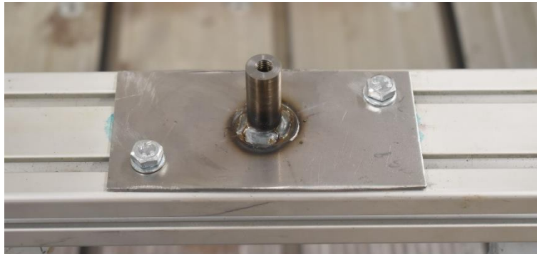
Obr. 56: Nově zhotovený přípravek pro ustavení volantu
