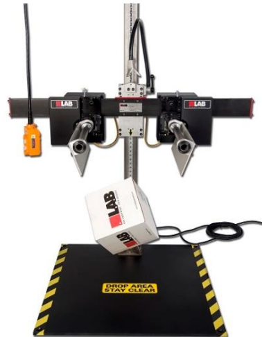
Obr. 21: Pádové zařízení s dvěma rameny (převzato z [16])
