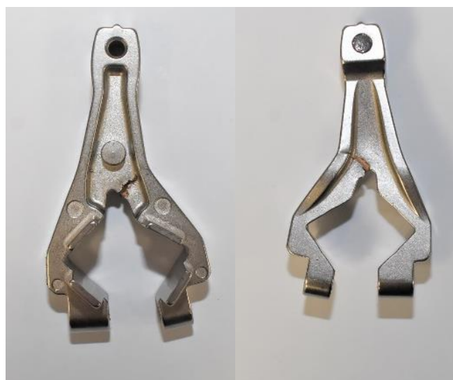
Obr. 19: Poškozené dorazová páka
