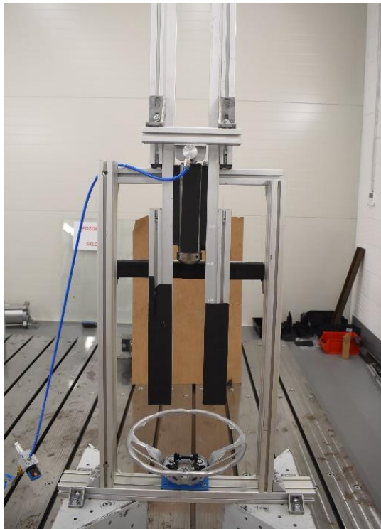
Obr. 52: Pádové zařízení pro moduly volantových airbagů
