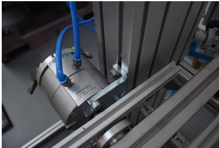
Obr. 15: Upínání kyvného pohonu ke nosnému konstrukčnímu profilu
