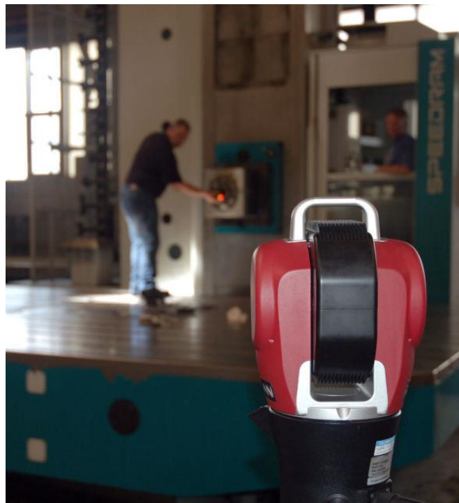
Obrázek 15: Skenování součásti pomocí laser trackeru API OT 2 core [34]
