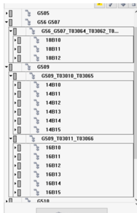
Obrázek 49: Roztříděné prvky do skupin dle několika nulových bodů a do podskupin dle kombinace několika nulových bodů a několika nástrojů
