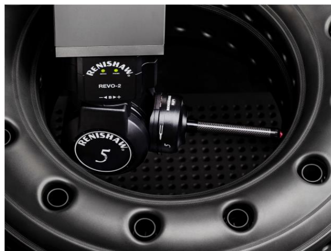
Obrázek 13: Automatická nastavitelná (motorická) snímací hlava s integrovanou spínací sondou Renishaw REVO 5 [31]
