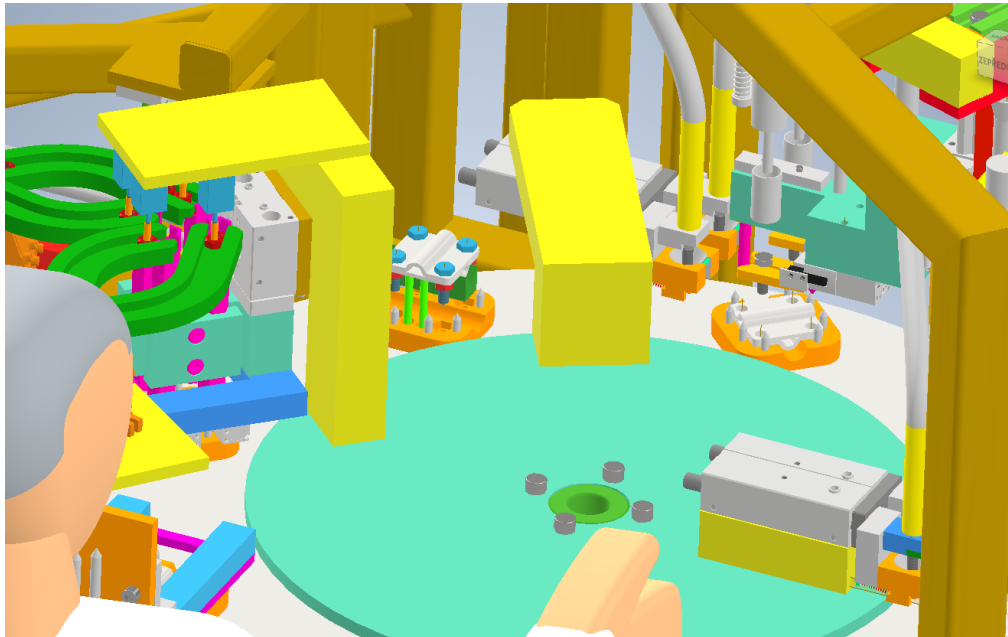
Obrázek 131 - Připevnění pneumatických válců ke středovému stolu
