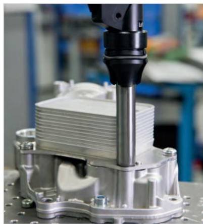
Obrázek 47 - Použití vakuové techniky k přidržení šroubu [54]
