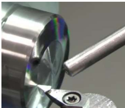
Obr. č. 45: Použití diamantového nástroje pro dokončení povrchu firmou LT ULTRA [39]
