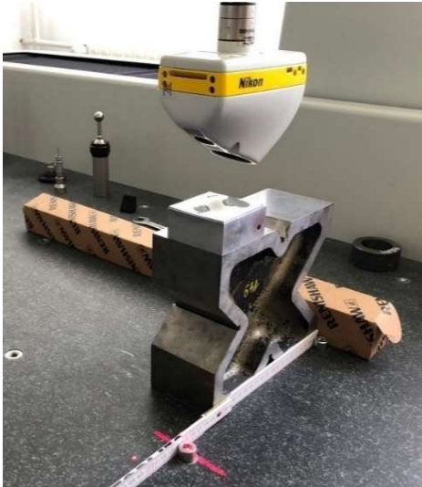
Obr. č. 103: Upnutí dílu pro měření na laserscanneru
