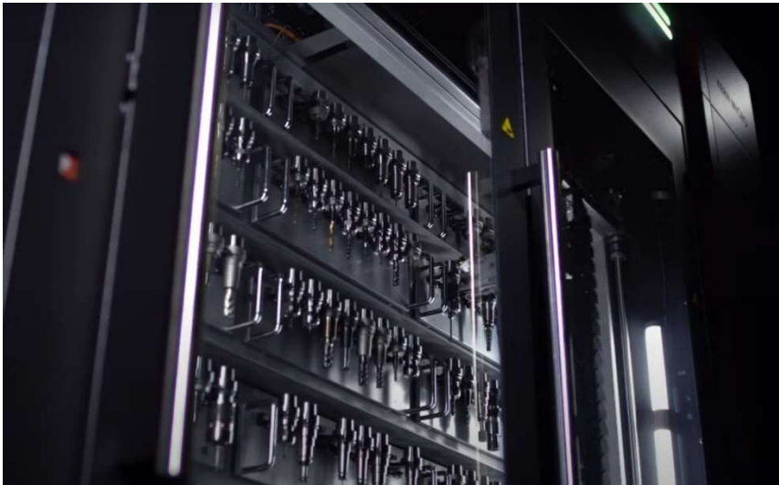
Obr. č. 47: Zásobník 120 nástrojů pro automatickou výměnu stroje KERN Micro HD [33]
