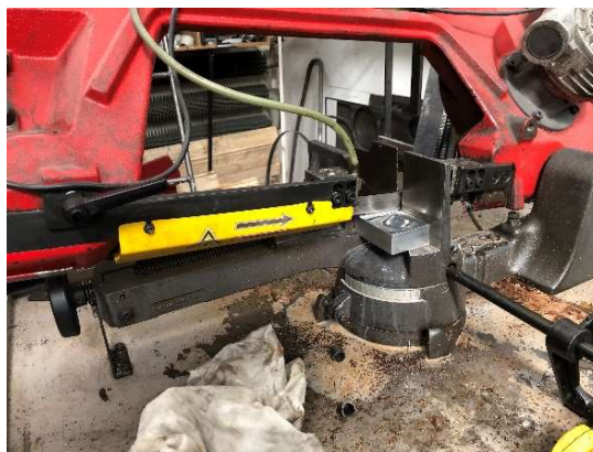
Obr. č. 51: Dělení na pásové pile Bomax
