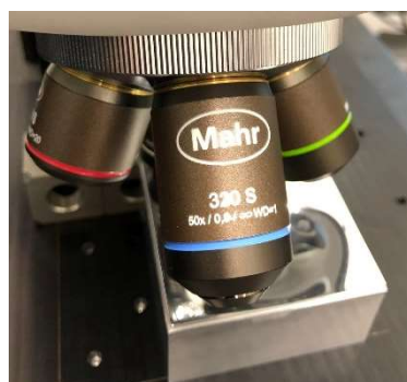
Obr. č. 86: Objektiv s 50ti násobným zvětšením obrazu
