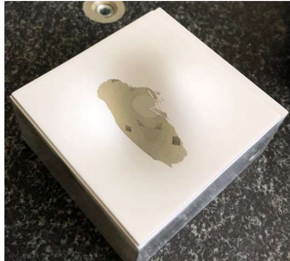
Obr. č. 104: Stírání zmatňujícího nástřiku z lesklého povrchu
