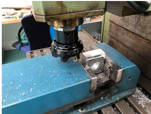
Obr. č. 52: Frézování boků etalonu
