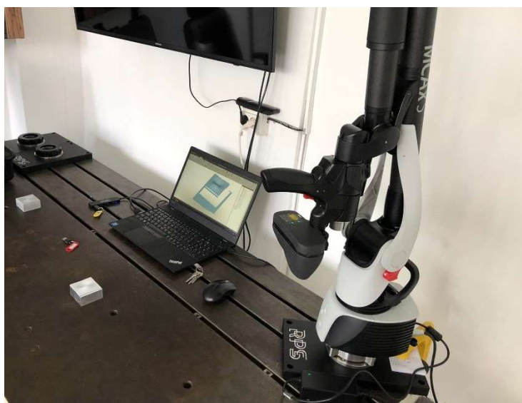
Obr. č. 113: Měřicí rameno laserscanneru a pracovní plocha
