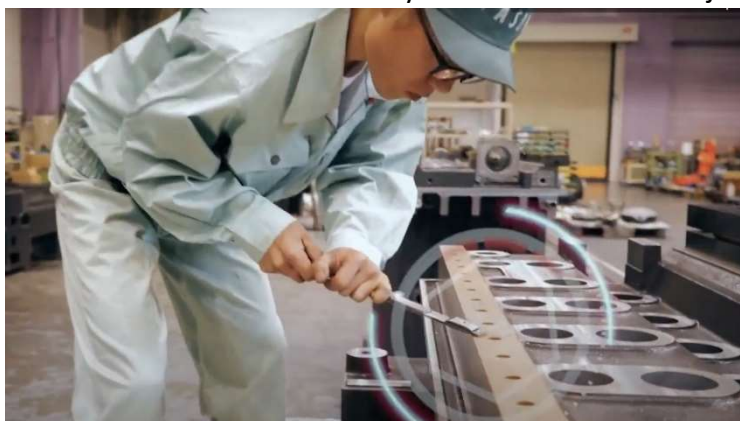
Obr. č. 39: Ruční škrábání vedení strojů Yasda [36]
