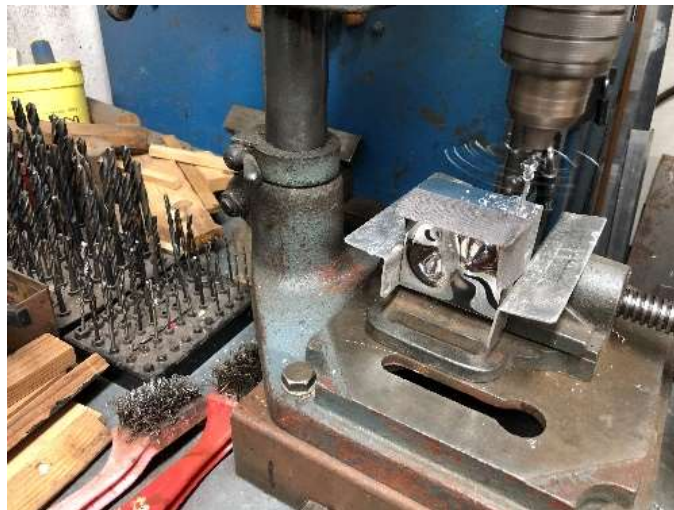
Obr. č. 56: Vrtání zavěšovacích otvorů
