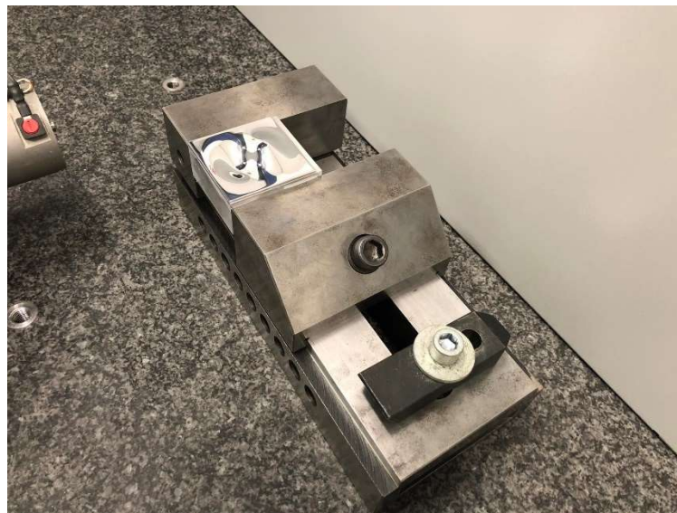
Obr. č. 80: Snímač z nitridu křemíku SiN a upnutí leštěné součásti do strojního svěráku
