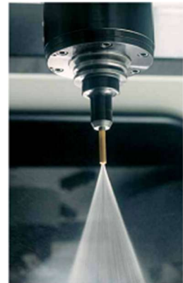
Obr. č. 48: Nástroj s technologií vnitřního chlazení firmy Haas [47]
