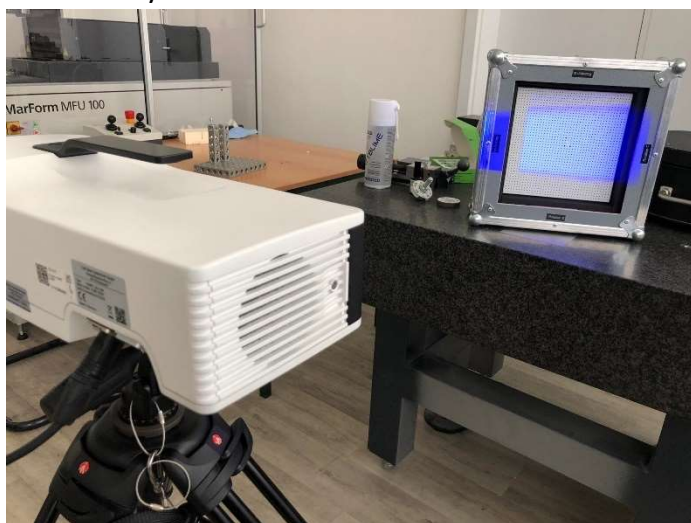
Obr. č. 97: Kalibrace Zeiss Comet L3D 2
