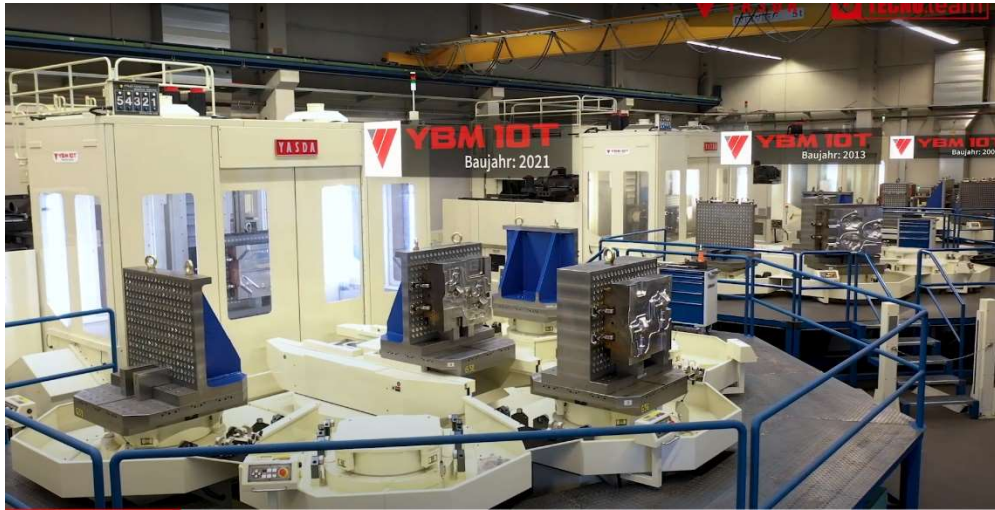
Obr. č. 44: Paletizace prováděná na stroji YASDA YBM 10T [36]
