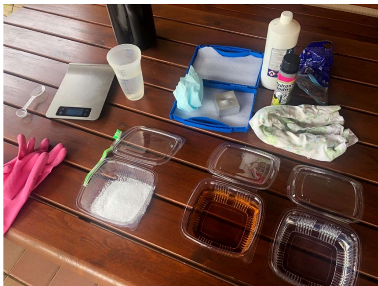
Obr. č. 62: Improvizovaná aparatura pro moření etalonu
