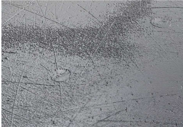
Obr. č. 88: 3D zobrazení důlků po snímači - 5x zvětšení
