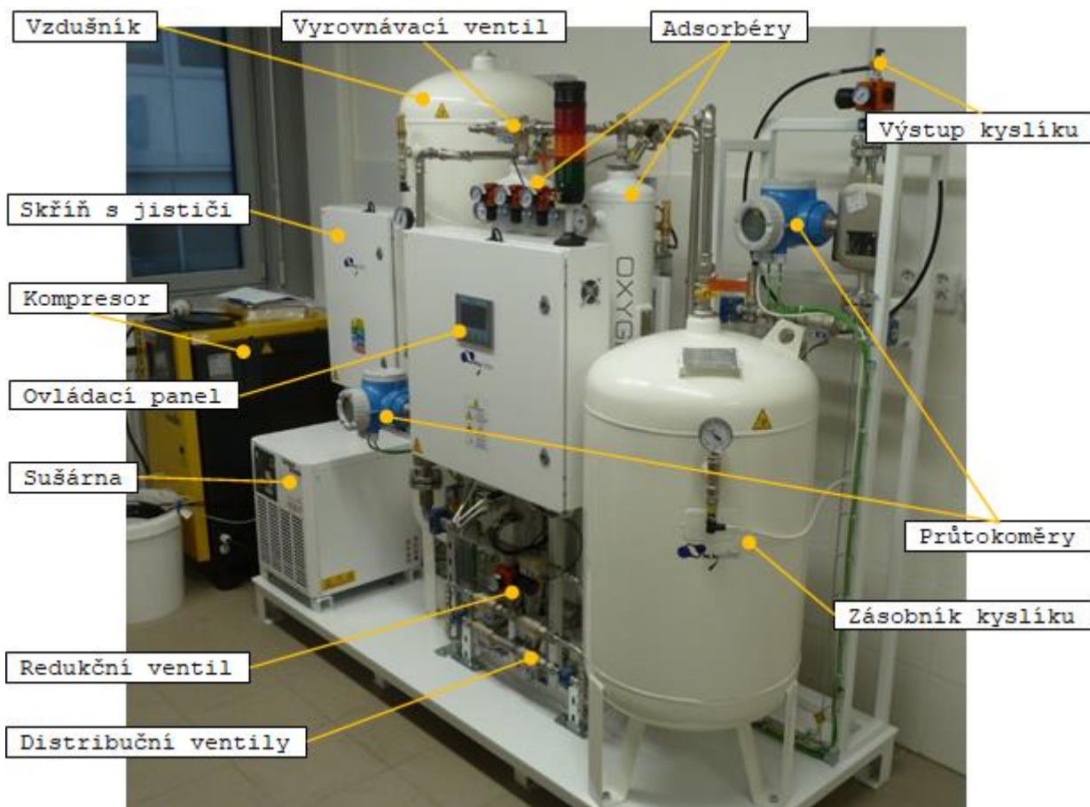
Obr. 4.1: Laboratorní adsorpční jednotka s popisem základních částí
