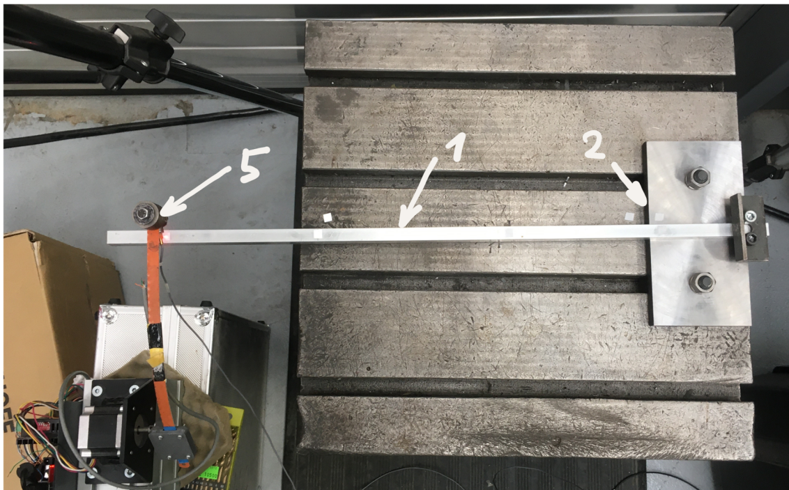
Obr. 5.5 Fotografie uspořádání experimentu, 1 – nosník, 2 – podkladový díl, 5 – automatické kladívko
