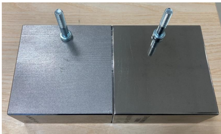
Obr. 22 – Ilustrační fotografie poskytnutých vzorků pro laserové leštění
