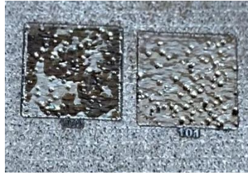
Obr. 33 – Srovnání použití ochranné atmosféry formou ofuku (vlevo) a formou argonové komory (vpravo)
