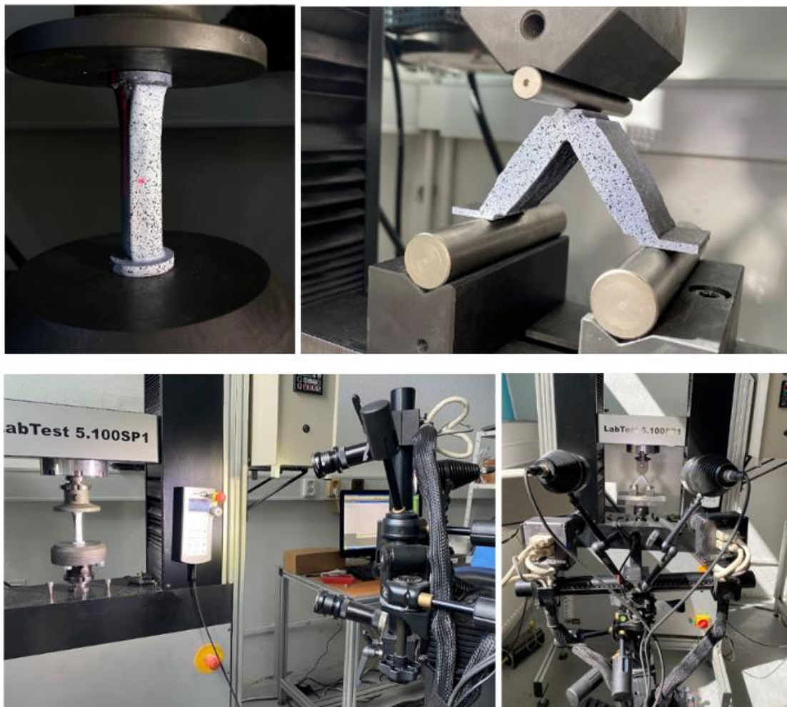
Obrázek 78: umístění vzorků do stroje pro snímání kamer
