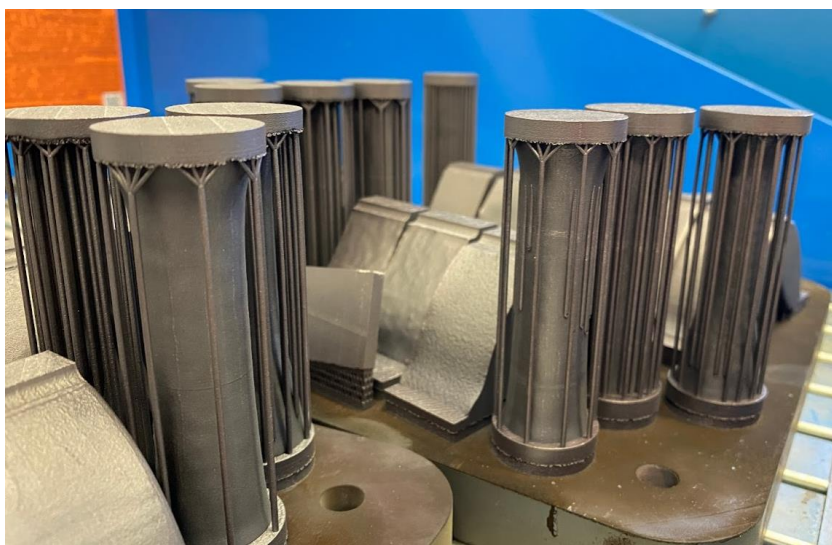
Obrázek 72: Vzorky po tepelném zpracování
