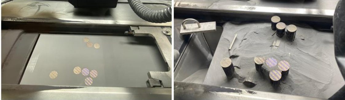
Obrázek 69: Ukončení tisku a odstraňování prášku
