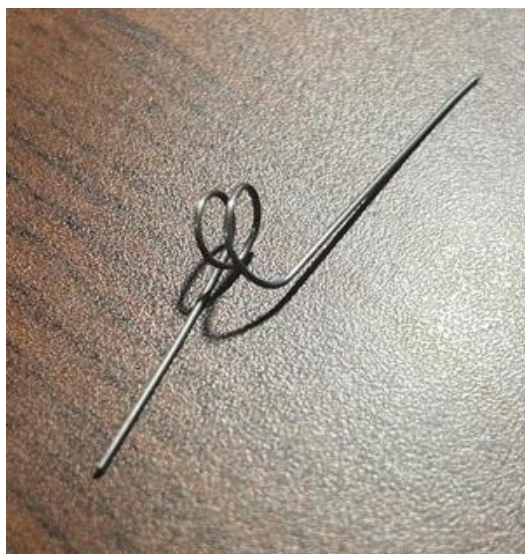
Obrázek 112 Vyrobená torzní pružina
