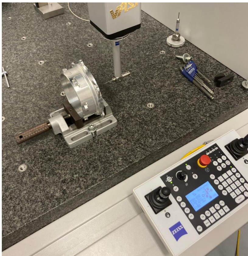
Obrázek 58: Snímač pro měření náboje, vzájemná poloha snímače a náboje a ovládací panel v pravém spodním rohu
