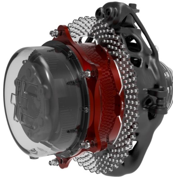
Obrázek 27: Schéma náboje v zapojení s krytem kola, vnitřním převodovým mechanismem a kotoučem
