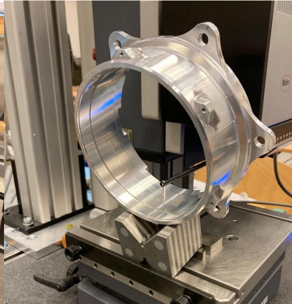
Obrázek 66: Upnutí součásti pro druhé měření
