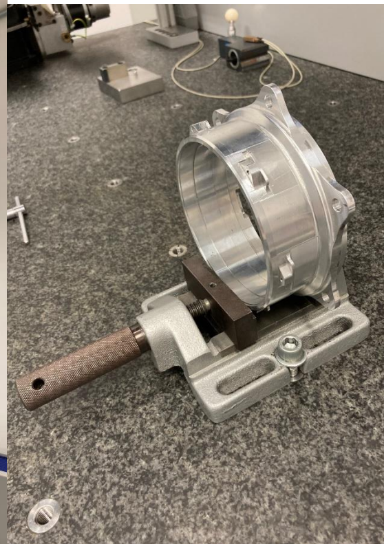
Obrázek 57: Uchycení náboje do svěráku
