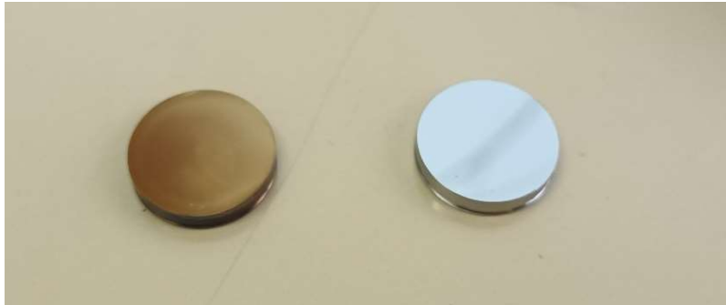
Obrázek 16: Vzorek po plazmové nitridaci (vlevo) a referenční vzorek.
