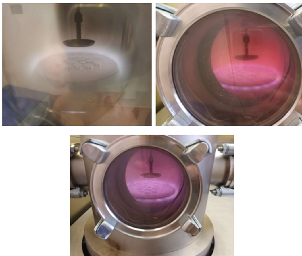
Obrázek 15: Zobrazení barev plazmatu v závislosti na použitém plynu.
