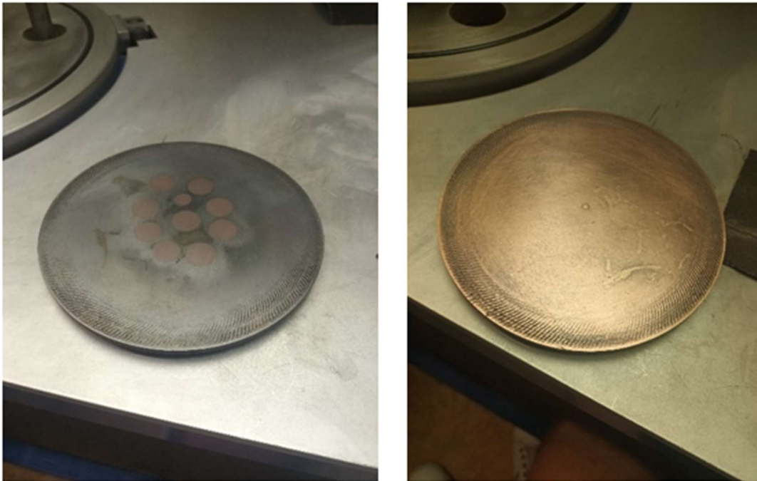
Obrázek 13: Zoxidovaného měděný stolek (vlevo) a vyčištěný stolek (vpravo).
