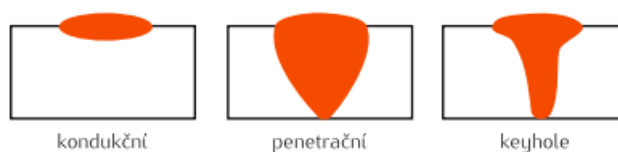
Obrázek 15: Techniky svařování laserem [11]
