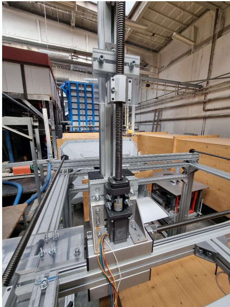
Obrázek 24: Připevnění motoru pro svislý posuv
