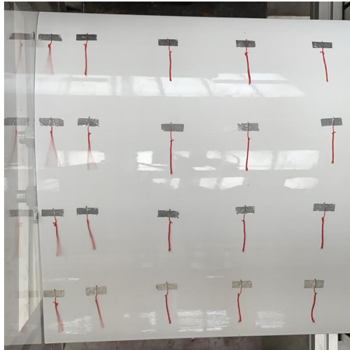
Obr. 31 Profil FX66-S-196V1, vizualizace pomocí vláken, \alpha = 0^\circ , Re = 200\ 000
