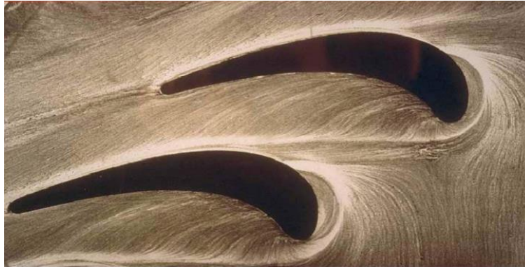
Obr. 25 Obtékání lopatek turbíny, vizualizace olejovým filmem [10]
