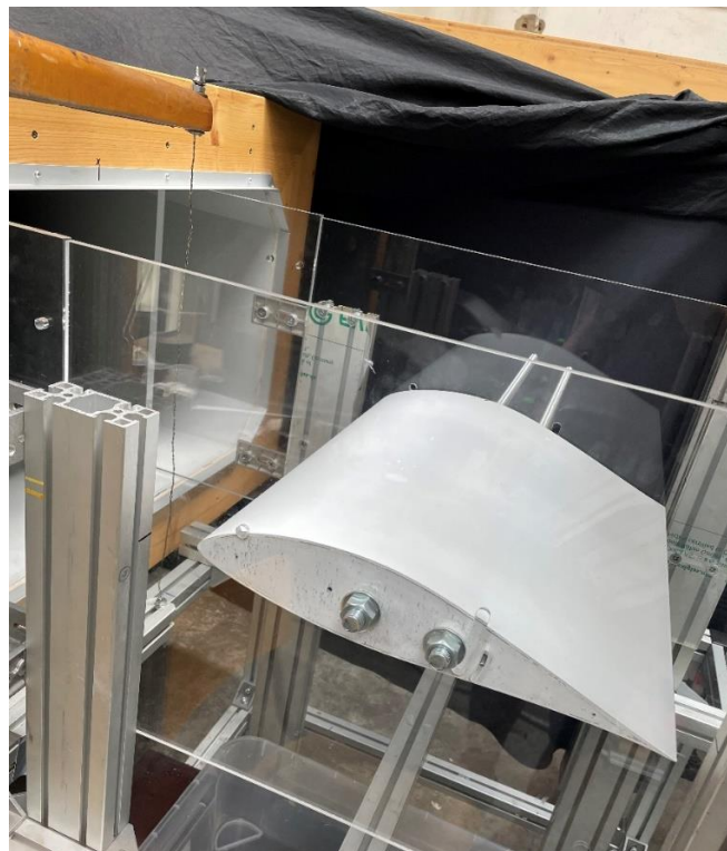
Obr. 30 Uložení profilu v měřicím prostoru
