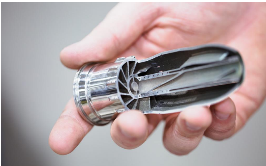
Obr. 8 Řez palivovou tryskou GE pro letecké motory [13]
