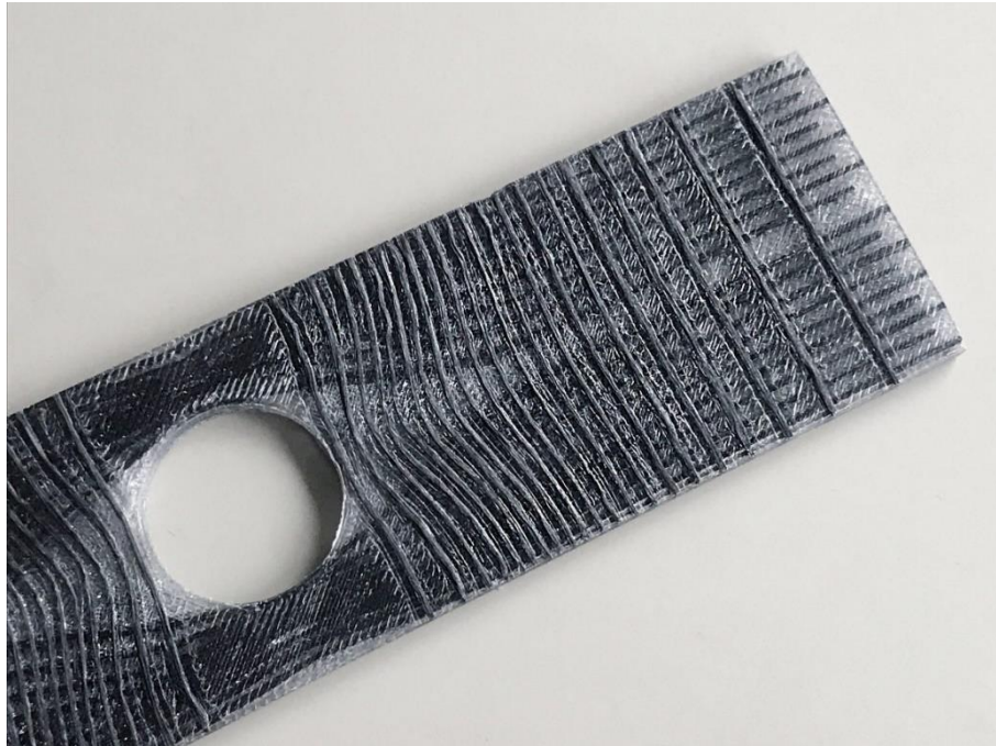
Obr. 7 Kompozitní komponent PETG+CCF vyroben metodou CFC [8]
