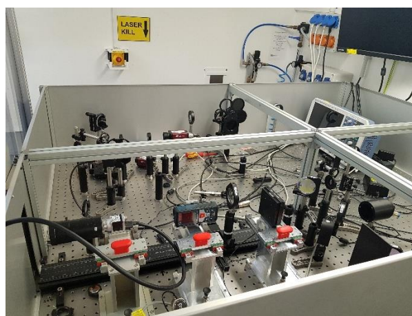
Obrázek 71: Konečný úsek optické soustavy laseru
