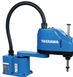
Obr. 4-5: SCARA od společnosti YASKAWA [15]
