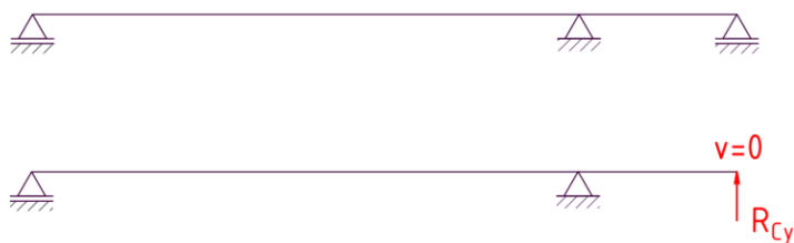
Obr. 28 - Deformační podmínka pro řešení staticky neurčitého výstupního hřídele
