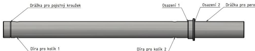
Obr. 31 - Kritická místa na výstupním hřídeli
