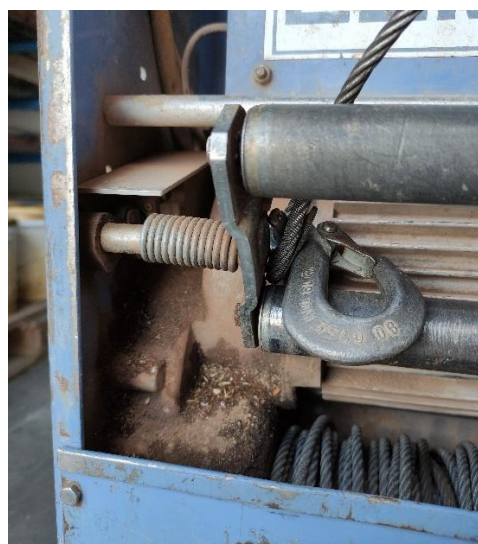
Obr. 8 - Ukládací mechanismus lana výtahu GEDA LIFT 250 Comfort
