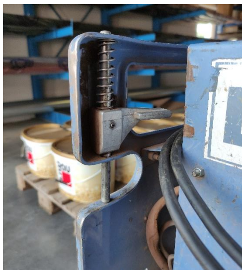
Obr. 7 - Rychloupínací systém výtahu GEDA LIFT 250 Comfort
