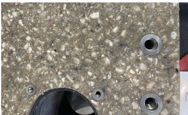
Obr. 12: Část stojanu z polymerního betonu s ocelovými inserty
