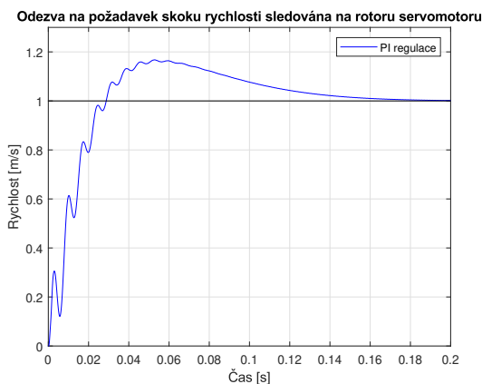
(a) Odezva hmoty rotoru na požadavek skoku rychlosti
