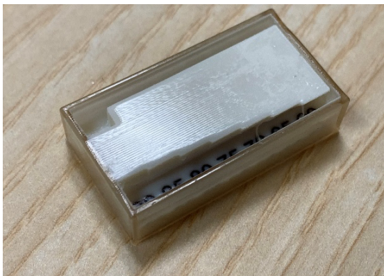
Obrázek 38 Výsledek experimentu s tekutými podporami
