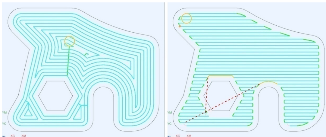
Obr. 20 Strategie frézování kapsy - konturování (vlevo), řádkování – cikcak (vpravo)
