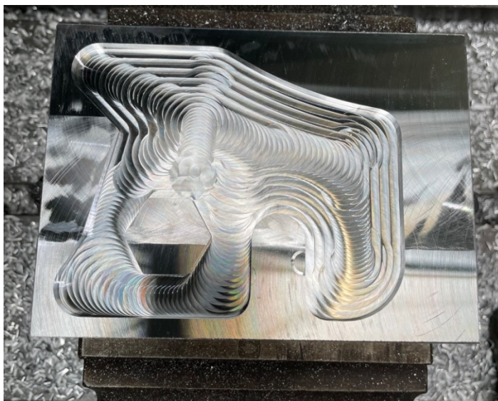
Obr. 23 Ukázka výsledného obrábění frézou S6118.0
