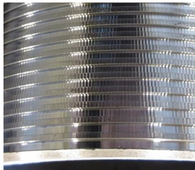
Obr. 6 - Ukázka obrobeného povrchu s projevem zvýšeného kmitání nástroje [13]
