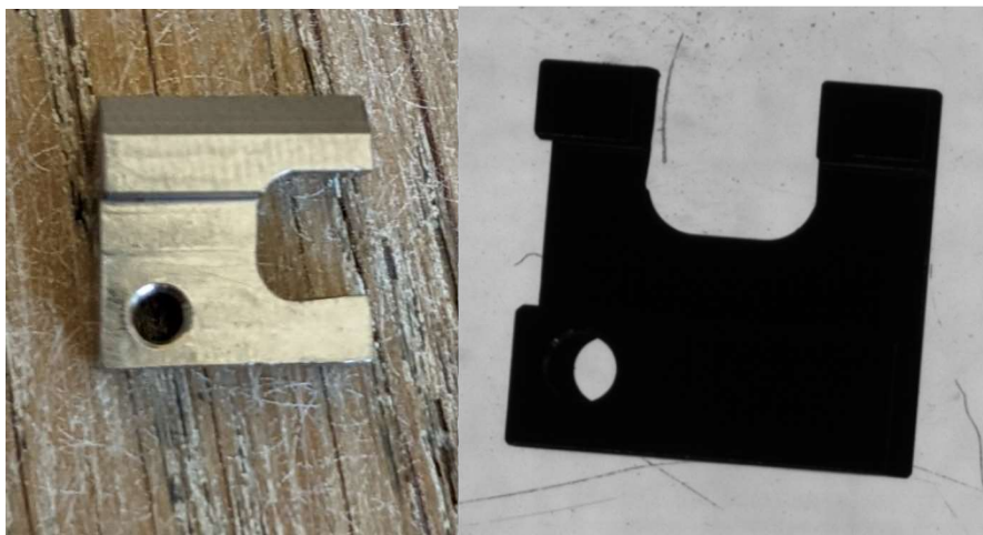
Obr. 54 Nepřesnosti měření při špatném uchopení
