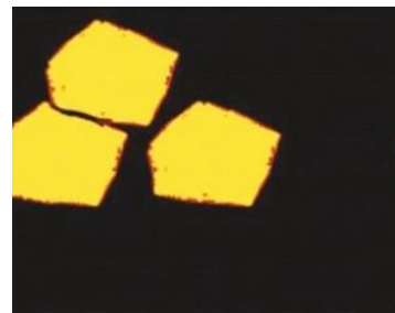
Obrázek 16 – fázový profil více částic Al-Si-10Mg při teplotním gradientu 263,33 K/mm [15]
