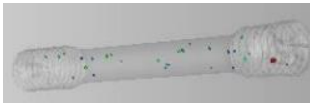
Obrázek 25 – CT snímek vzorku 3D tištěné slitiny AlSi10Mg [45]
