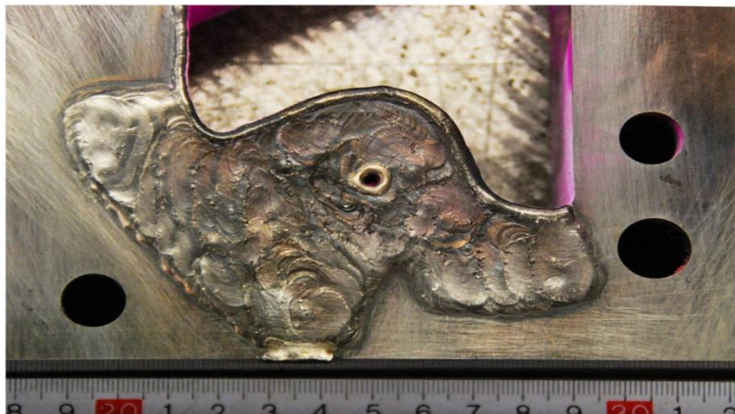
Obrázek 22 - Navařování chybějícího materiálu na formu pro HPDC [52]
