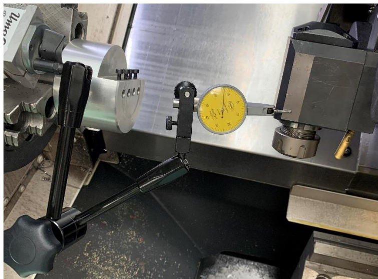
Obrázek 34: Upnutí úchylkoměru pro zarovnání osy nástroje
