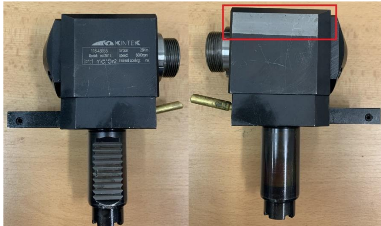
Obrázek 23: Kintek 116-43035 (2516) s označenou funkční plochou
