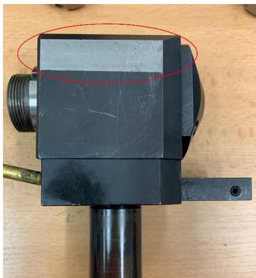
Obrázek 31: Kintek 116-430535 (2516) s označenou funkční plochou
