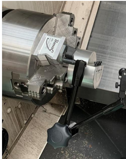
Obrázek 18: Uchycení přípravku a stojánku pro úchylkoměr
