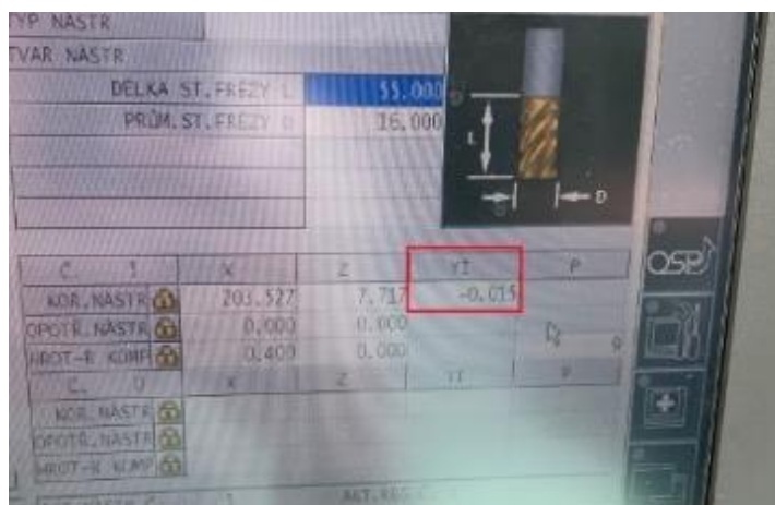
Obrázek 38: Hodnota korekce nástroje v ose Y
