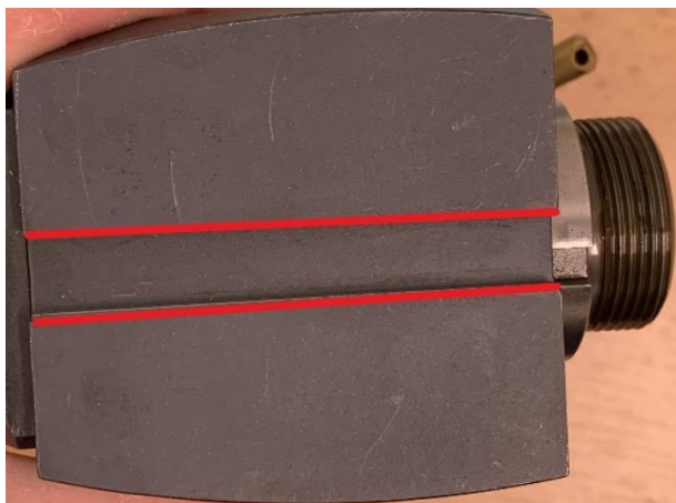
Obrázek 25: Kintek 116-43036 (2709) s označenými funkčními plochami
