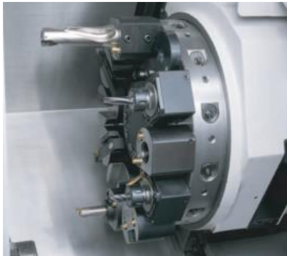
Obrázek 4: Revolverová hlava VDI na soustruhu OKOUMA GENOS L200E-MY [3]
