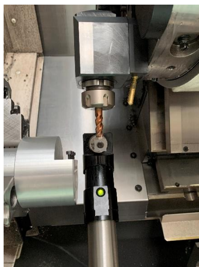
Obrázek 27: Nastavení korekce v ose X
