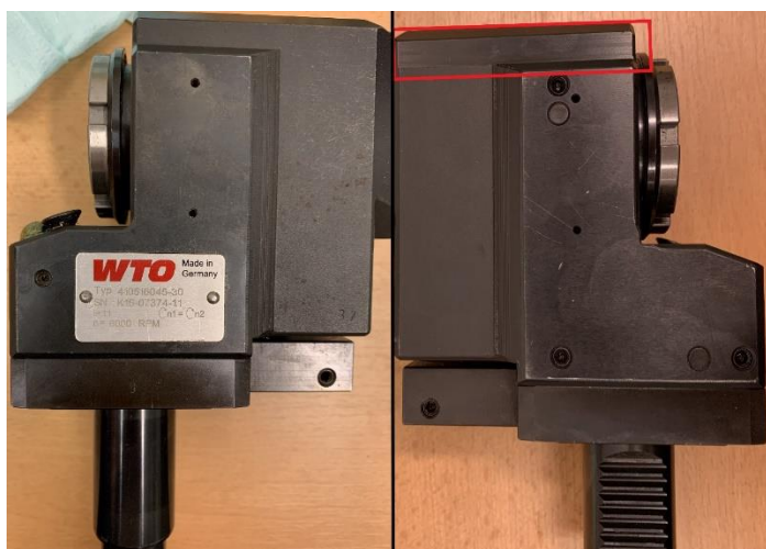
Obrázek 26: WTO 410516045 s označenou funkční plochou
