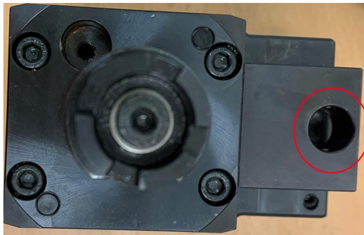
Obrázek 11: Šroubky pro zarovnání držáku
