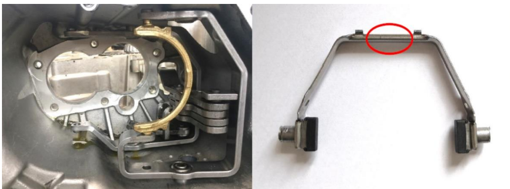
Obrázek 30 Tříbodový styk pomocí mosazného půlměšice vlevo, pomocí profilovaného plechu vpravo [6]
