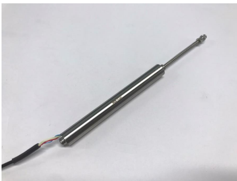
Obrázek 26 Snímač LVDT OP12.5 s tlačnou pružinkou a kuličkovým koncem [zdroj: autor]
