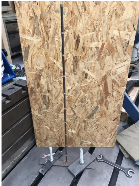
Obr. 4 - Vzorek a jeho upevnění k zemi
