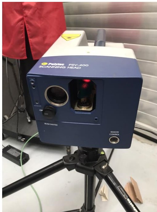
Obr. 5 - PSV-400 od firmy Polytec (Skenovací hlava)
