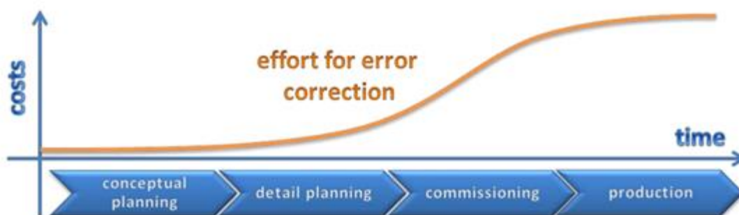
Obr. 1 – Náklady na nápravu chyb a problémů v závislosti na časovém okamžiku ve výrobě (hrubé plánování, detailní plánování, zprovoznění a produkce) [2]
