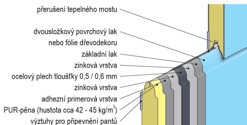
obr. 6.: Vrstvy lamely [5]
