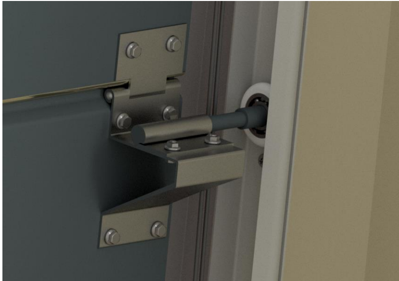
obr. 8.: Ukázka pantu včetně pojezdového kolečka [obrázek autora]
