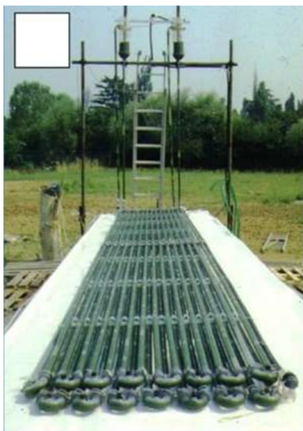
Obr. 5 Příklad trubkového fotobioreaktoru horizontálního [23]
