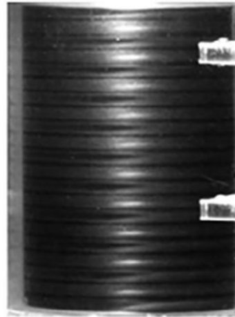
Obr. 21 Vzor Taylorovo vírového proudění [32]
