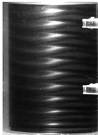
Obr. 22 Vzor vlnivě vírového proudění [32]
