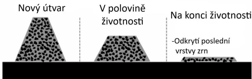
Obr. 30 Mechanismus opotřebení strukturovaného pásu [29]
